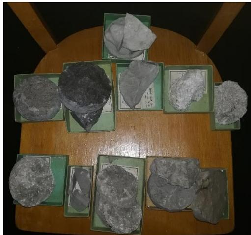
Abbildung 10: Alle vorhandenen Bohrkernproben der Bohrung Achau 1 im Tiefenintervall zwischen 210 und 271,5 m aus dem Archiv der GBA in Wien
