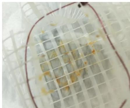
*Abbildung 34: Lösungsrückstand der Probe W3 im Plastiknetz*
