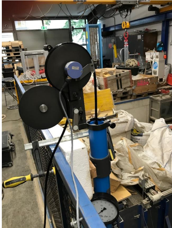
Abb. 3 Messvorgang IDM, Druckanzeige für Wasserdruck im Ringraum Außenrohr - IDM-Messrohr
