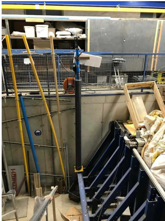
Abb. 1 Versuchsstand: Außenrohr (grau) mit eingebautem IDM-Messrohr (blau)
