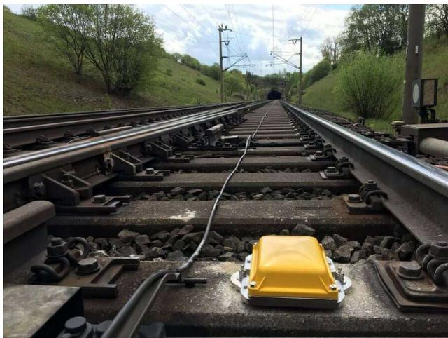
Abbildung 2-2: Sensor KONUX-System<sup>2</sup>
