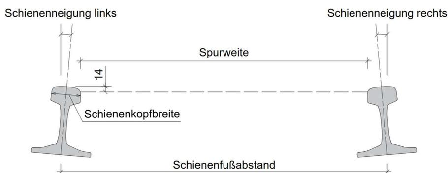
Abbildung 4-4: Zusammenhang Schienenneigung – Spurweite<sup>8</sup>
