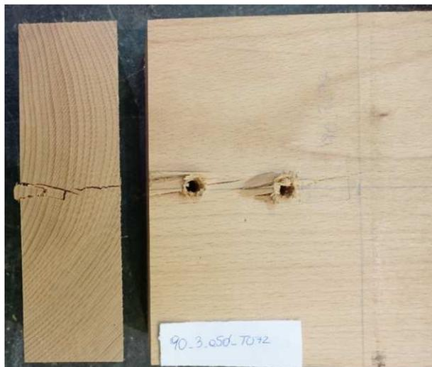
**Abbildung 4-9** Rollschubversagen bei Serie R5d mit  $a_1 = 5 d$
