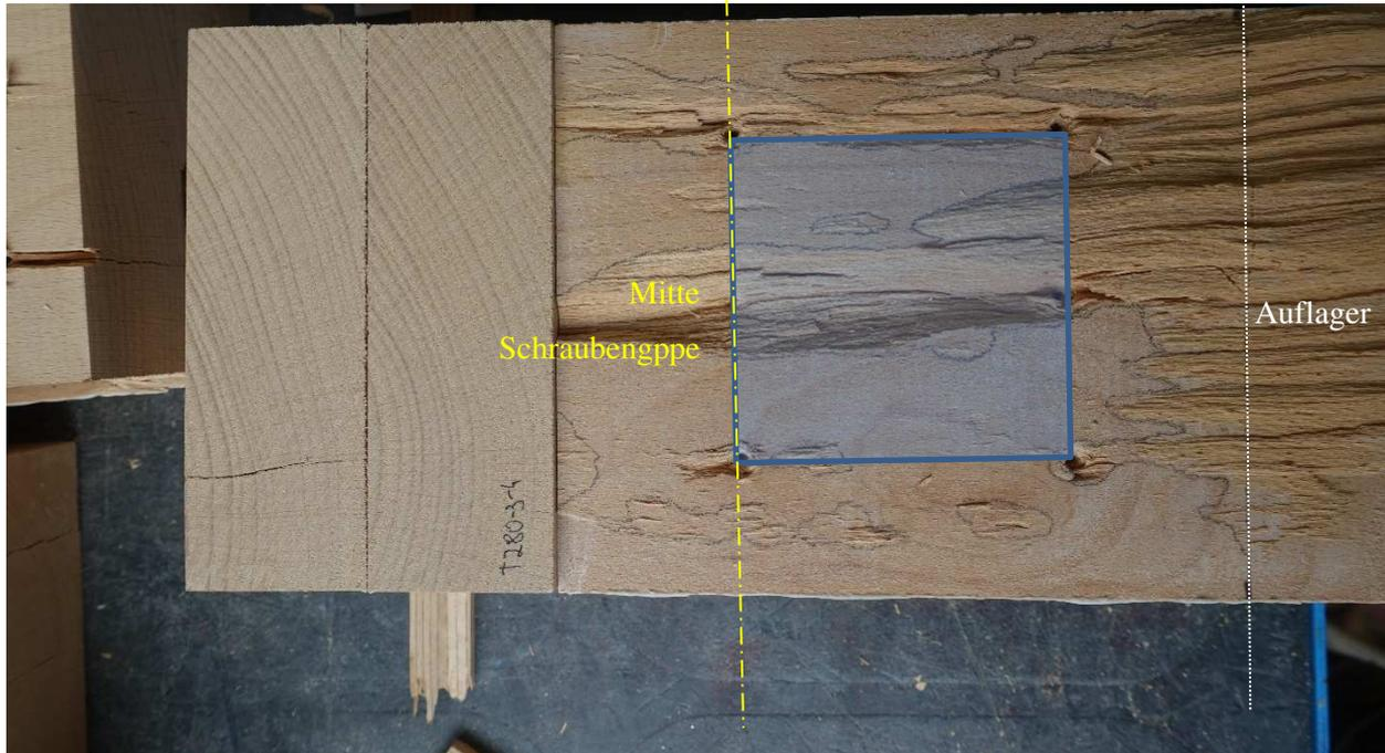
**Abbildung 3-21** Auswertung Anteil Klebefugenversagen, halbe Fläche innerhalb der Schraubengruppe
