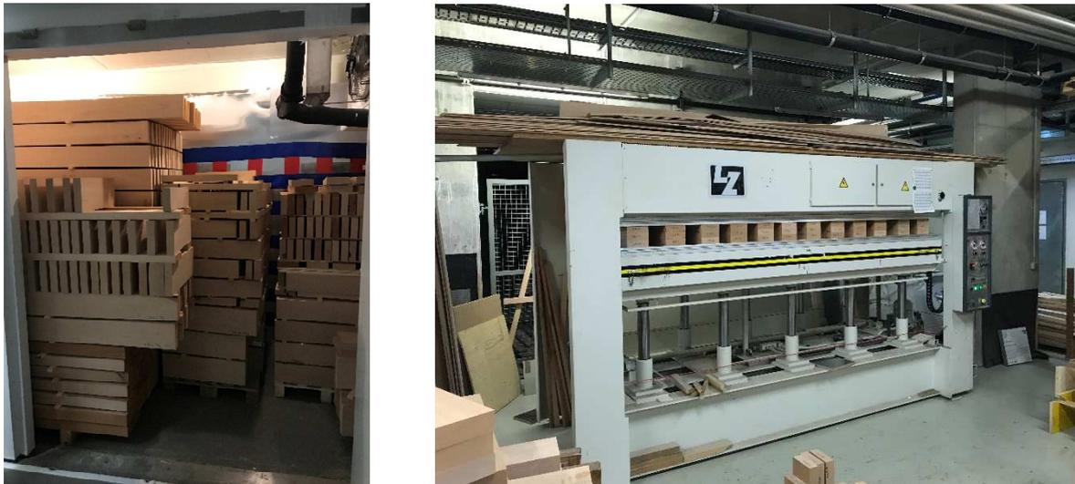
Abbildung 3-11 Lagerung Klimakammer (links), Verklebung der Prüfkörper in der Presse (rechts)
