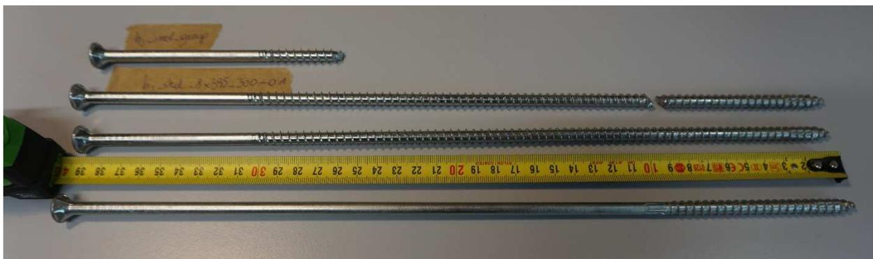
Abbildung 4-18 Schraubenbruchbereiche, Vergleich Referenz (zweite von oben) Gruppe (oben)
