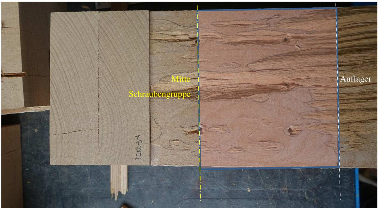
**Abbildung 3-20**     *Auswertung Anteil Klebefugenversagen, halbe Fläche zwischen Mitte der Schraubengruppe und Auflagerrand*
