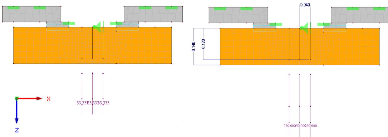
Abbildung 4-21 RFEM Modell; Vergleich mit Serie 8, Belastung links 30 kN, Belastung rechts 90 kN
