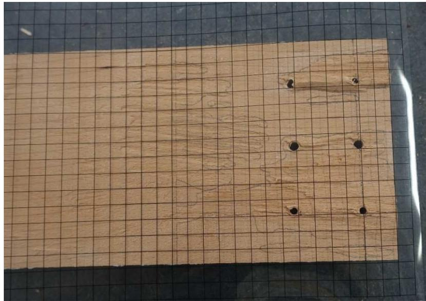
**Abbildung 3-19**     *Quantifizierung des Klebefugenversagens*
