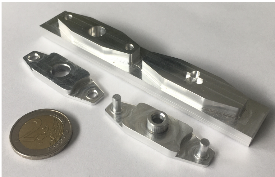
Abbildung 4.1: gefertigtes Referenzbauteil mit Zwischenstufe (Quelle: Eigene Darstellung)
