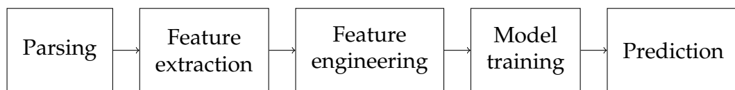
Abbildung 3.2: Ablauf der Erstellung von Machine Learning-Vorhersagen (Quelle: Eigene Darstellung)
