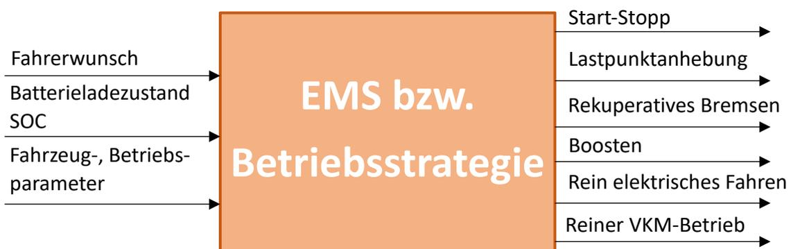
Abbildung 3-2: Übersicht der Betriebszustände eines Parallelhybrid [6]
