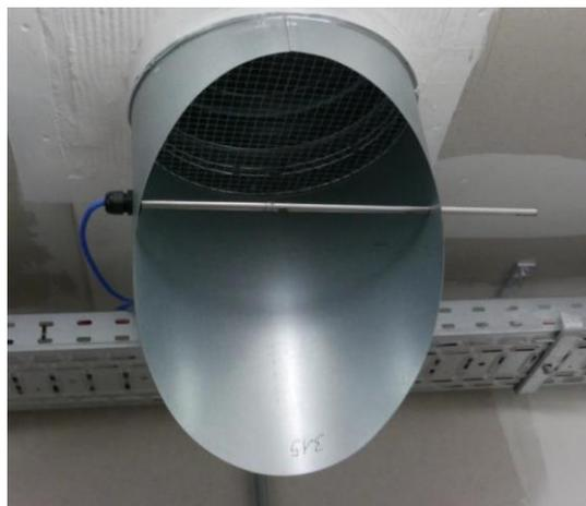
Abbildung 2-11: Messung der Strömungsgeschwindigkeit mittels Hitzdrahtanemometer der Fa. Höntzsch – Zuluftkanal [17]
