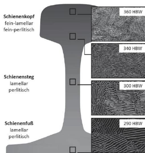
Abbildung 1-15: Schienenprofil – Schienenstahlsorte R 350 HT
