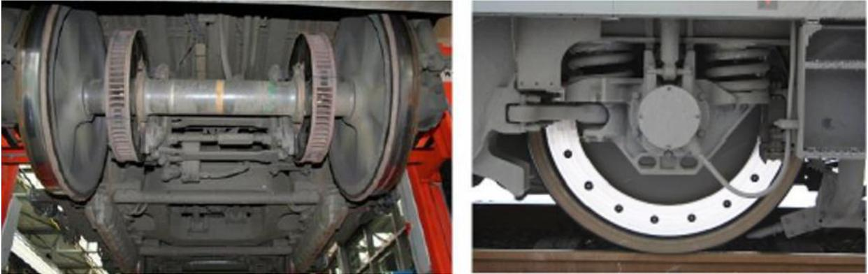
Abbildung 1-10: Bauarten: Wellenbremsscheibe (links) und Radbremsscheibe (rechts) [39]
