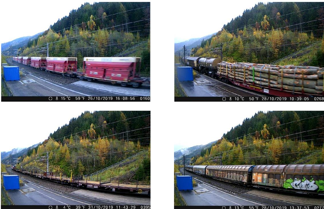
Abbildung 2-28: oben links: Wagen (offen), Beladungszustand (-), Beladung (-); oben rechts: Wagen (kombiniert), Beladungszustand (-), Beladung (Holz); unten links: Wagen (offen), Beladungszustand (unbeladen), Beladung (-); unten rechts: Wagen (geschlossen), Beladungszustand (-), Beladung (-)
