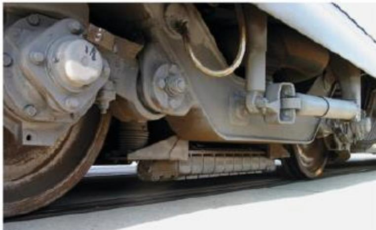
Abbildung 1-12: Magnetschienenbremse [15]
