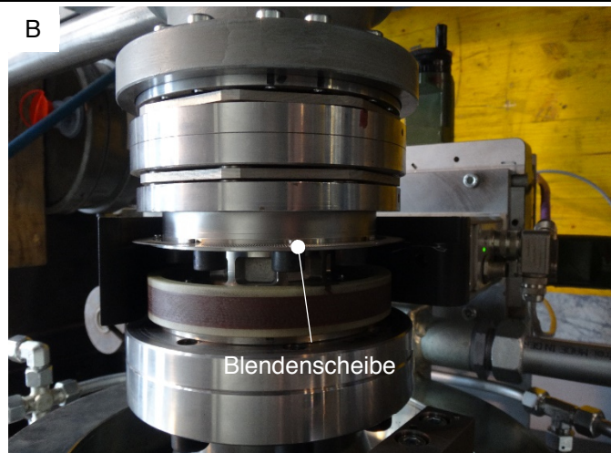
Abbildung 2-14: Inkremental-Drehgeber-Blendenscheibe aus [21, p. 258] (A); Messflansch mit Inkremental-Drehgeber (B)
