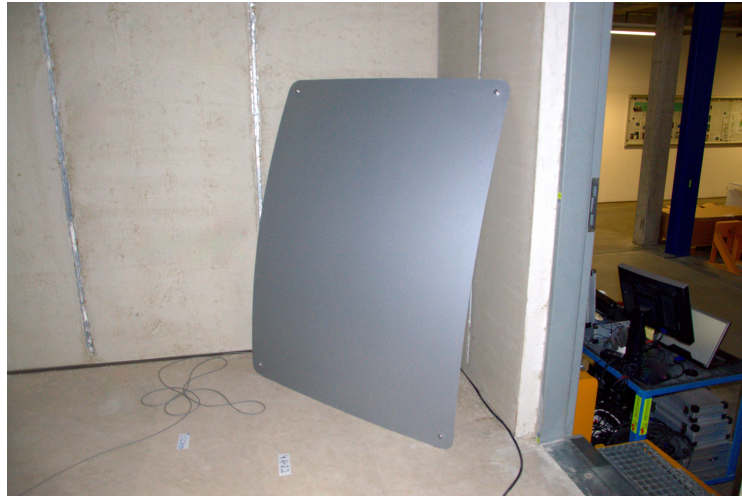
Abbildung 4.12.: Der eingebrachte Diffusor im Senderaum.
