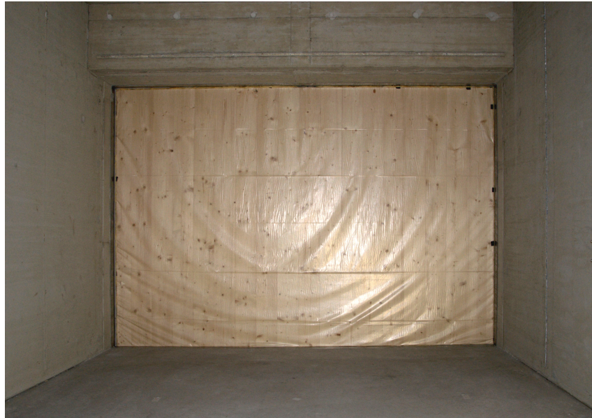
Abbildung 4.4.: Die im Prüfstand eingebaute BSP-Wand, vom Senderraum aus betrachtet.
