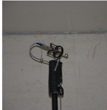
Abbildung 4.8.: Messung der Frequenzen der ersten Raummoden, Mikrofonposition M1
