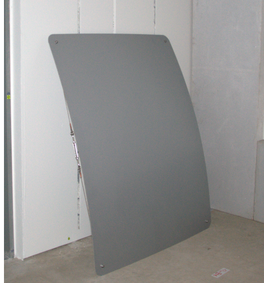
Abbildung 4.5.: Die verwendeten Diffusoren aus vorgespanntem ALUCOBOND® PLUS.
