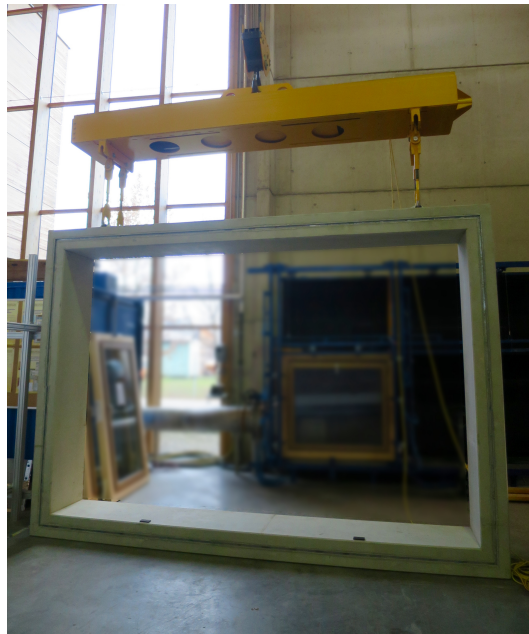
Abbildung 4.2.: Der leere Stahlbetonrahmen in dem später der Prüfkörper eingebaut wurde. An der Unterseite sind die beiden schwarzen Elastomere erkennbar auf denen der Prüfkörper gelagert wurde.
