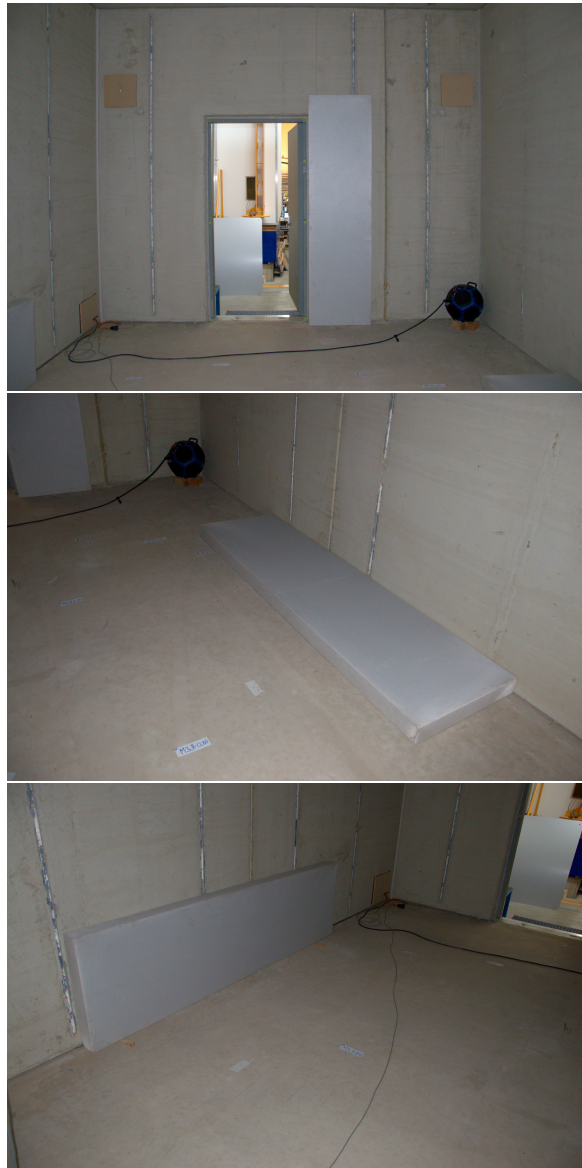
Abbildung 4.14.: Die eingebrachten Absorber A1-A3 (Oben: A1, Mitte: A2, Unten: A3)
