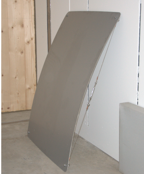
Abbildung 4.5.: Die verwendeten Diffusoren aus vorgespanntem ALUCOBOND® PLUS.
