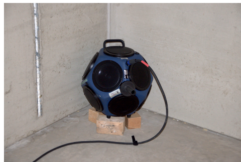
Abbildung 4.9.: Lautsprecher an Position LS1 in einer Ecke des Senderraums. Zur Vermeidung von Schäden an der bodengerichteten Lautsprechermembran wurde der Lautsprecher auf Holzblöcken platziert.
