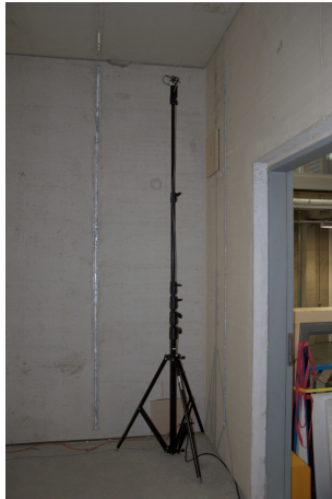
Abbildung 4.8.: Messung der Frequenzen der ersten Raummoden, Mikrofonposition M1
