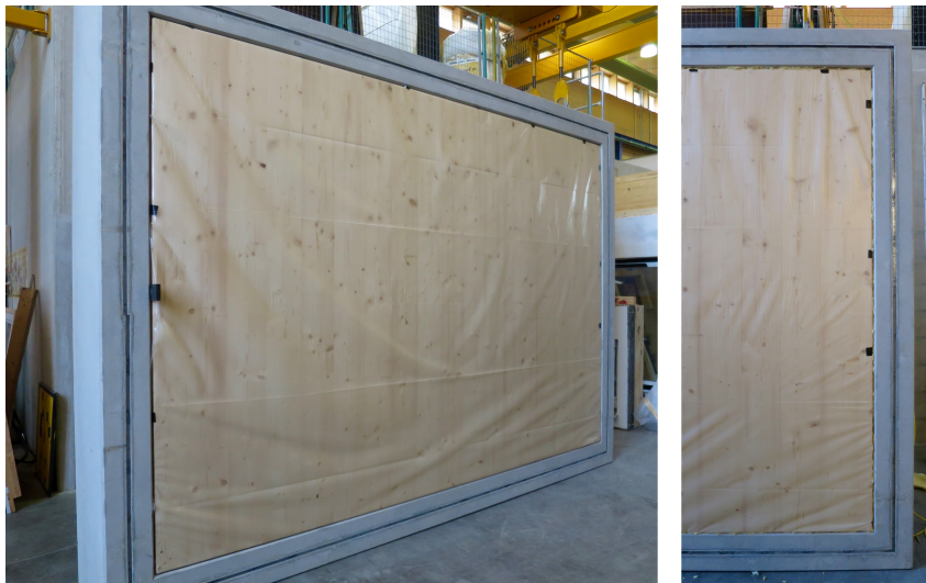
Abbildung 4.3.: Der im Rahmen fixierte Prüfkörper (links). Die Fuge zwischen Prüfkörper und Einbaurahmen wurde mit Mineralwolle gefüllt (rechts).
