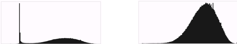
Abbildung 5.10.: Screenshots aus COMSOL die die Elementqualitäts-Histogramme bei automatischer Vernetzung (links) und bei modifizierter Vernetzung (rechts) zeigen.
