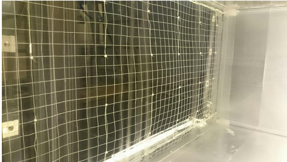
Abbildung 4-19: Temperaturmessgitter am ExHX-Austritt
