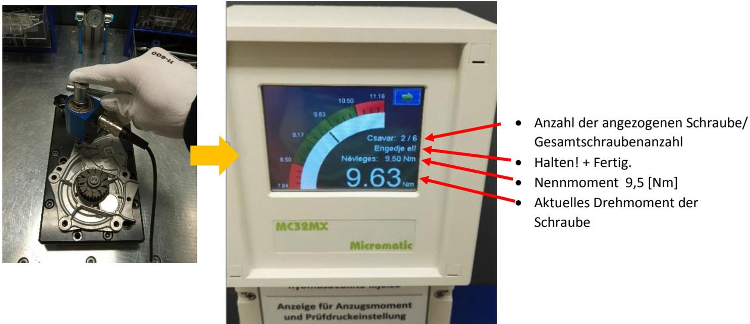
Abbildung 29: Links: Festziehen der Schrauben mittels Drehmomentschlüssel
