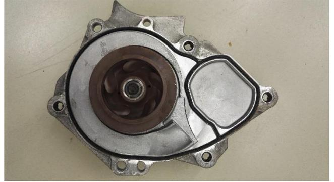
Abbildung 26: Kühlmittelpumpe EA888 Gen. 3
