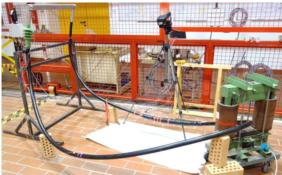
Bild 5.1: Versuchsaufbau zur Untersuchung des Temperaturprofils der Kabelgarnituren
