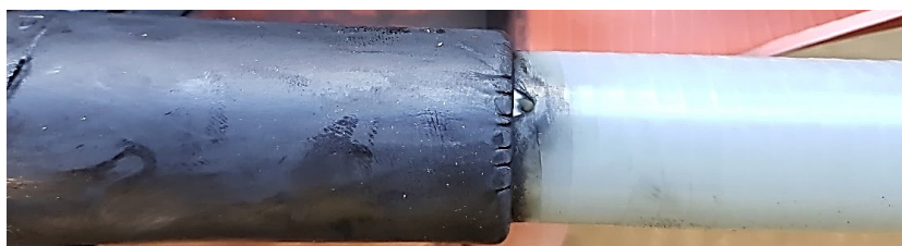
Bild 8.5: Durchschlag im Prüfendverschlussbereich (Prüfling P7)
