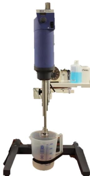
Abbildung 24: Verwendetes Dispergiergerät IKA ULTRA TURRAX T 50 DIGITAL
