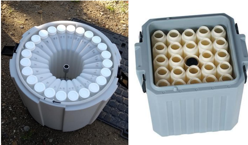
Abbildung 13: Probenahmeuntersatz des E+H-Probenahmegerät (links) und MAXX-Probenahmegerät (rechts)
