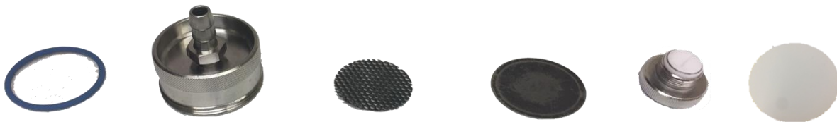
Abbildung 26: Silikon-O-Ring, Filtertisch, Lochblech, 0,45 µm Membranfilter, Siebplatte und Verschlusskappe für die Einfüllöffnung (von links nach rechts)
