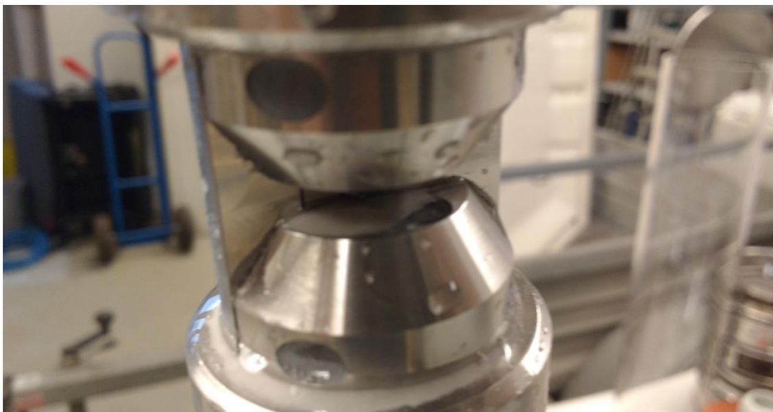
Abbildung 3-10: Sedimentfilm auf dem Messfenster der Spektrometersonde bei der Vermessung von synthetischen Proben.
