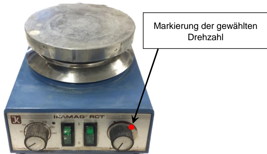
Abbildung 20: Magnetrührer mit Markierung für die Drehgeschwindigkeit
