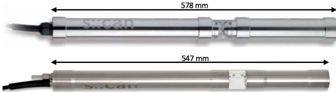
Abbildung 6: spectro::lyser Sonde der zweiten Generation (Firma s-can: http://www.s-can.at , Stand 2017-09-19)
