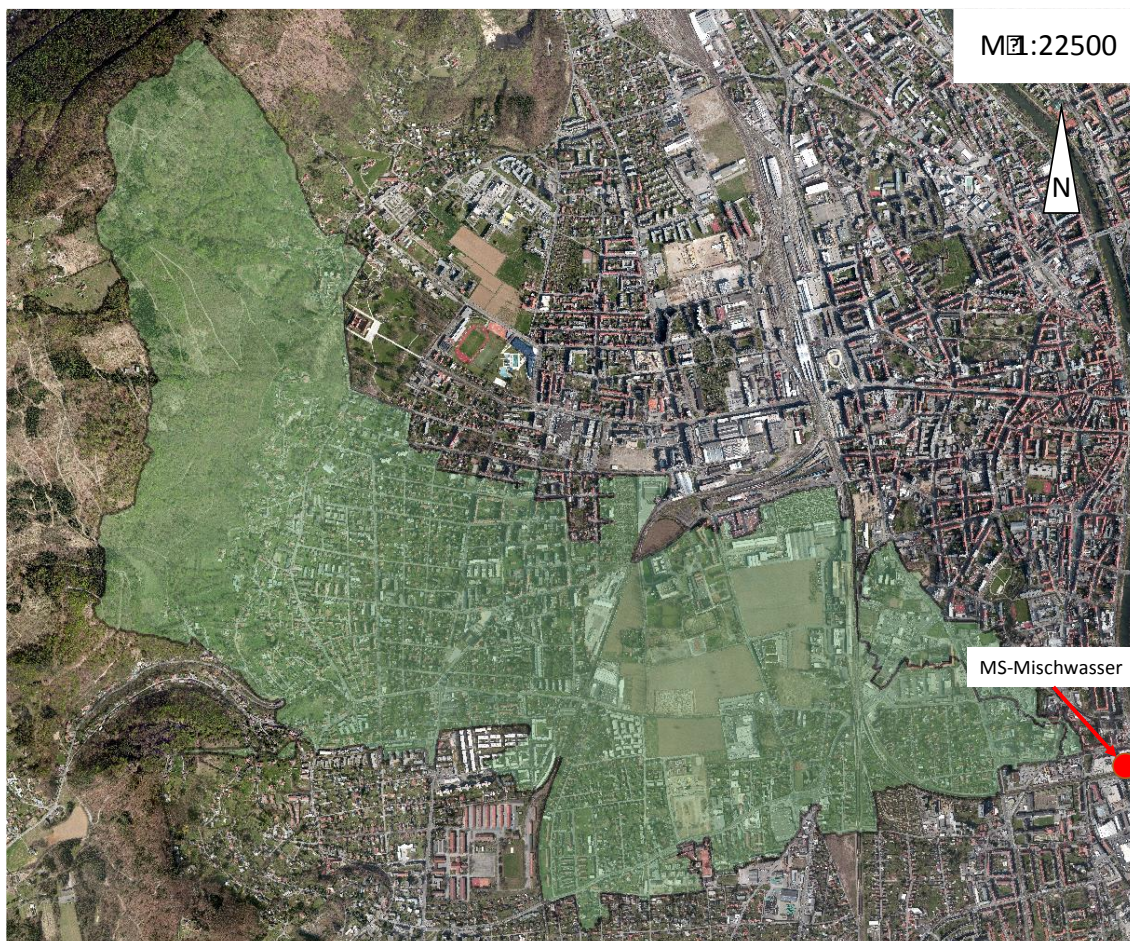
Abbildung 2-18: Lage und Einzugsgebiet der Messstelle Graz-Mischwasser
