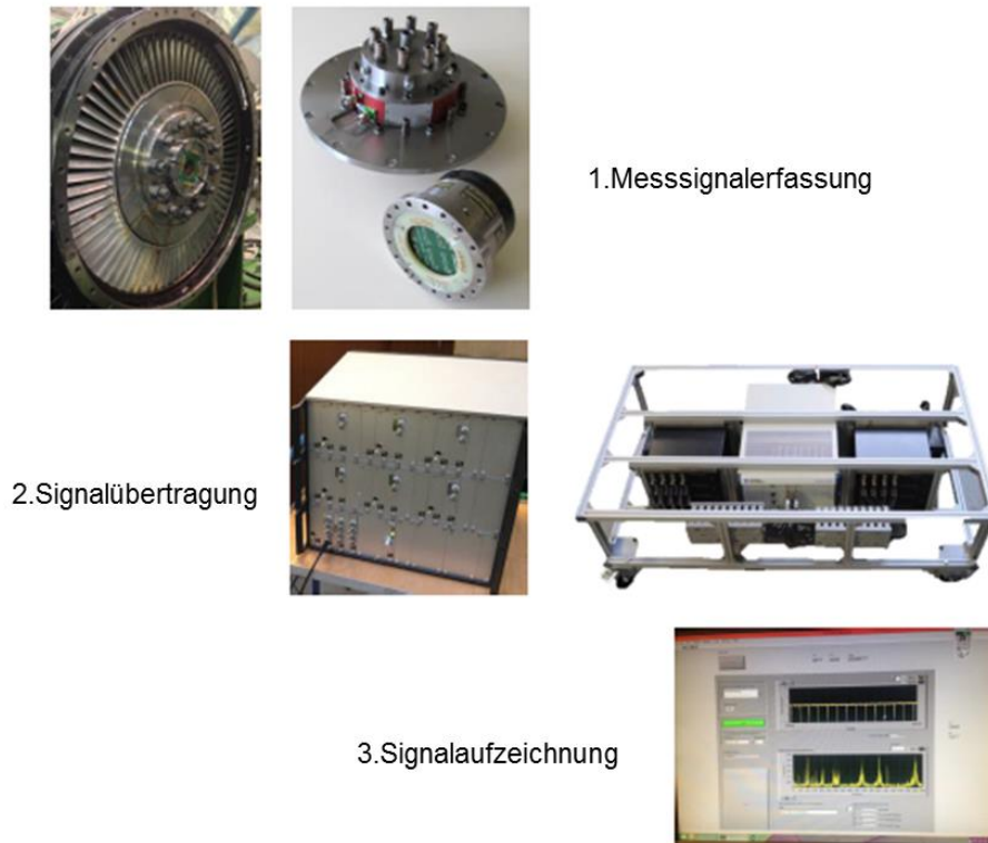
Abbildung 35: Signalfluss bei der Messung [7]
