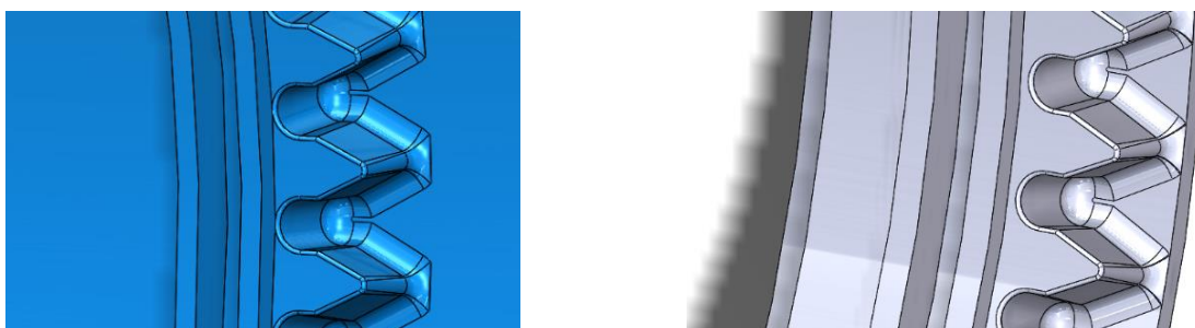
Abbildung 33: Innenverzahnung an Gehäuse und Verzahnungsbuchse, Quelle: Eigene Darstellung
