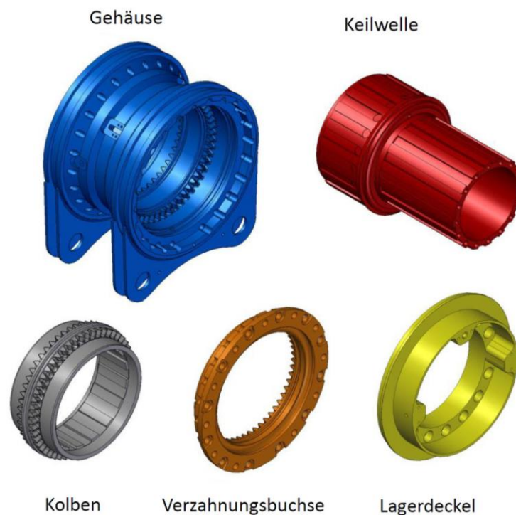
Abbildung 1: Hauptkomponenten des Hydraulikmotors, (D.Kriegl, 2018), S.4.
