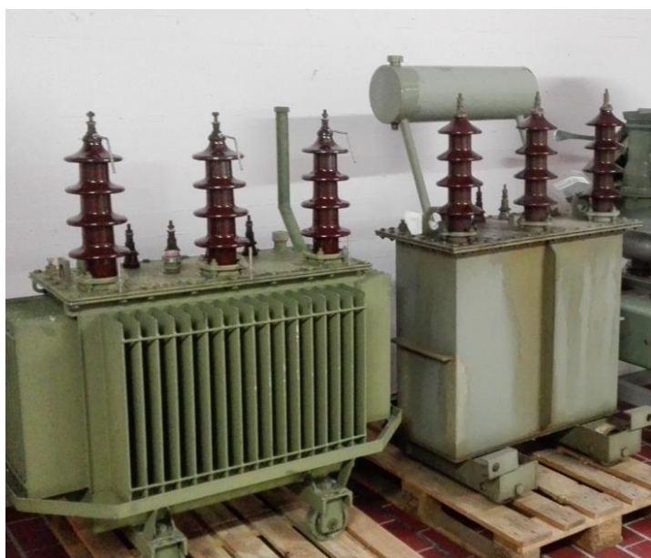
Abbildung 7-8: Zwei Yzn5 50 kVA Transformatoren ähnlicher Leistung
