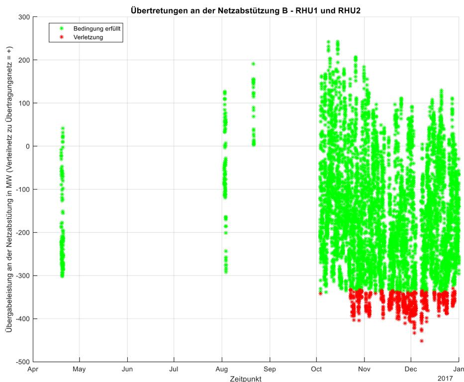
Abbildung 4-5: Zeitliche Aufteilung der (n-1)-Übertretungen – Netzabstützung B bei RHU1 und RHU2
