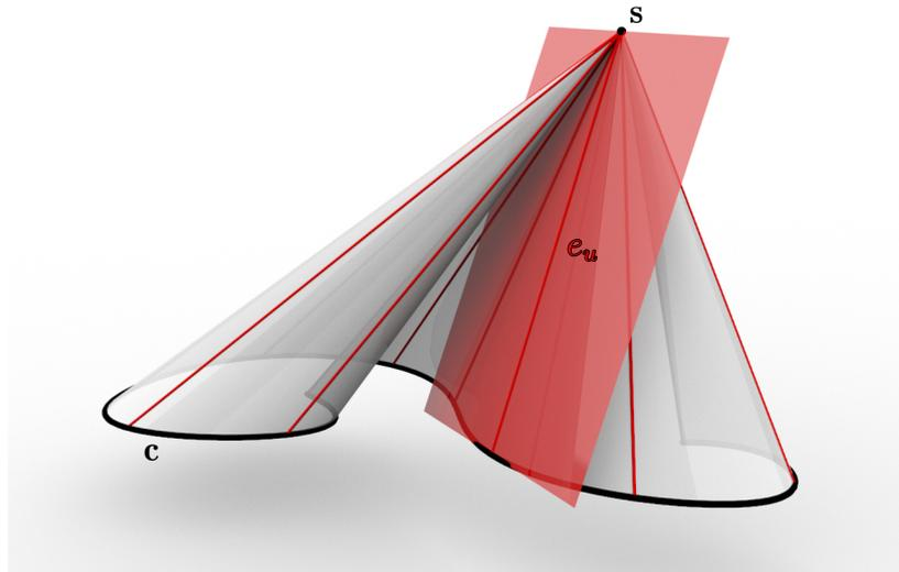
Abbildung 1.25: Kegelfläche mit Leitkurve  $\mathbf{c}$ , Spitze  $\mathbf{s}$ , Erzeugenden  $e_u$  und einer Tangentialebene entlang dieser Erzeugenden.
