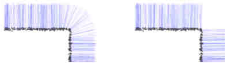
Abbildung 28 links Standard Methode (Durchschnitt der umliegenden Punkte), rechts Hough Methode (Boulch A. & Marlet R., 2012).
