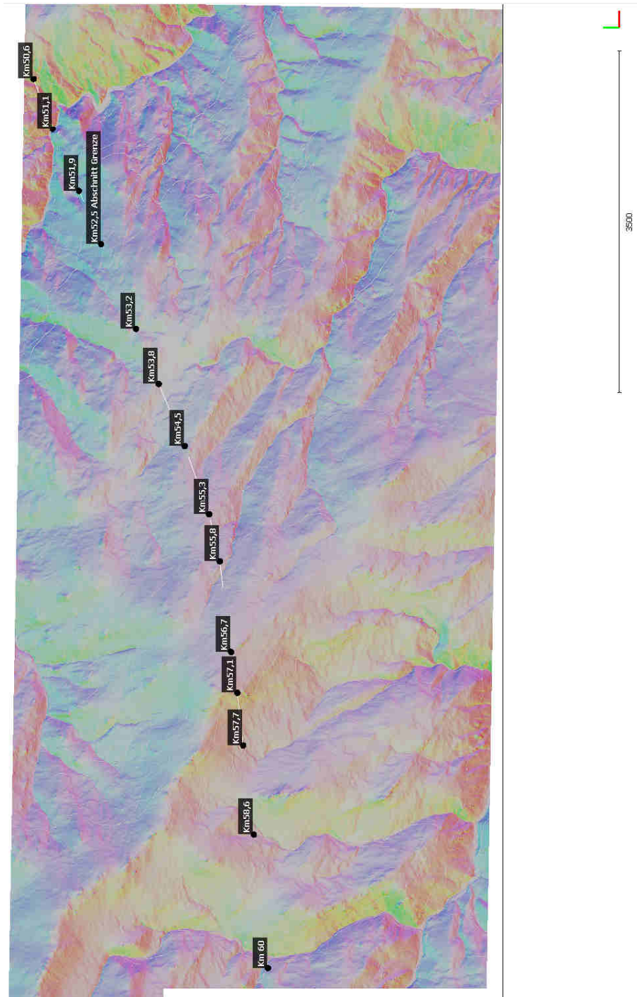
Abbildung 69 Gefügehomojenbereich Zentral mit Kilometrierung auf der Tunnelachse. Mittels HSV-Farbschema eingefärbt, bezogen auf dip und dip dir.
