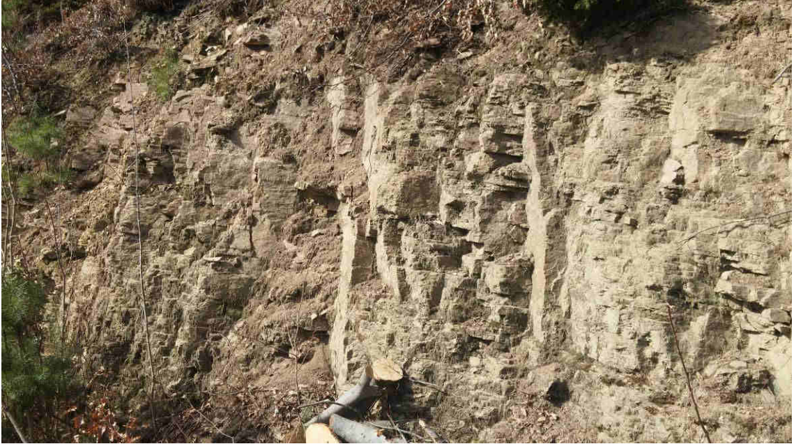
Abbildung 22 Detailbild Gefüge: Plattengneis Typus Stainz mit zwei Kluftscharen K1 / K2 und der Schieferungsfläche SF.
