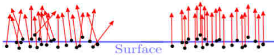
Abbildung 29 Oberflächendarstellung (links) falsch (rechts) mit Hough (Boulch A. & Marlet R., 2012).
