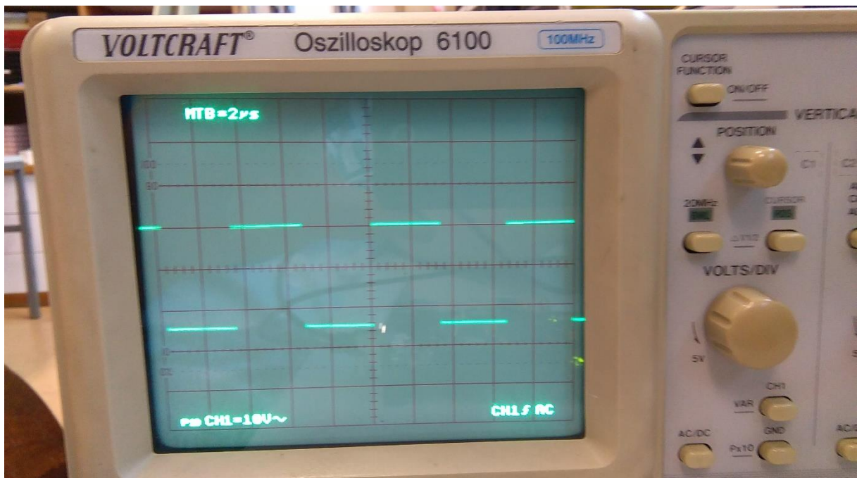
Abbildung 74: Taktsignal des UART-Empfängers mit optimalen Einstellungen
