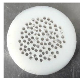
Abbildung 47: Sieb (Lochscheibe aus PTFE) für den statischen Mischer
