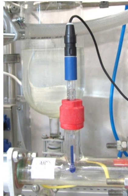
Abbildung 41: Messstelle der pH-Wert Messung in der Rückflussleitung
