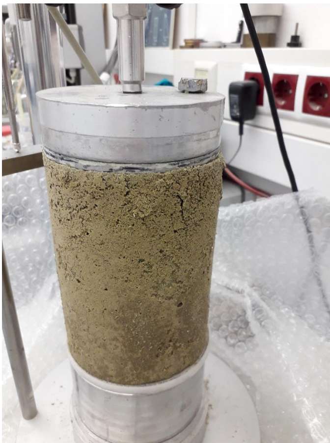
Abb. 18: gebrochene Probe (Probenalter: 35 Tage)
