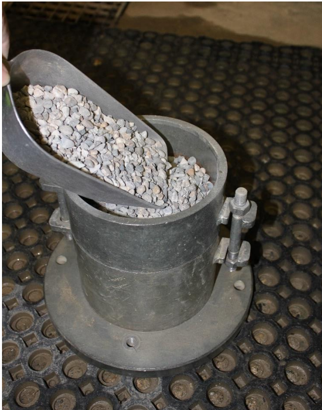
Abb. 28: Einbringen des Materials
