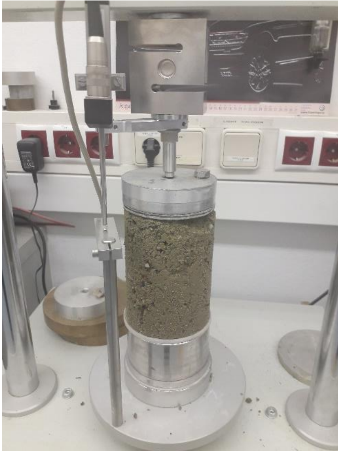
Abb. 8: gebrochene Probe (Probenalter: 3 Tage)
