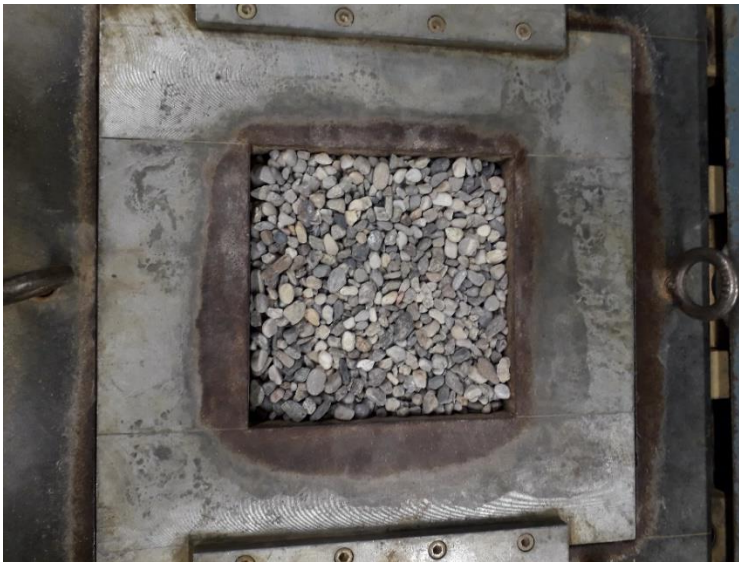
Abb. 35: In die Scherbox eingebaute Probe
