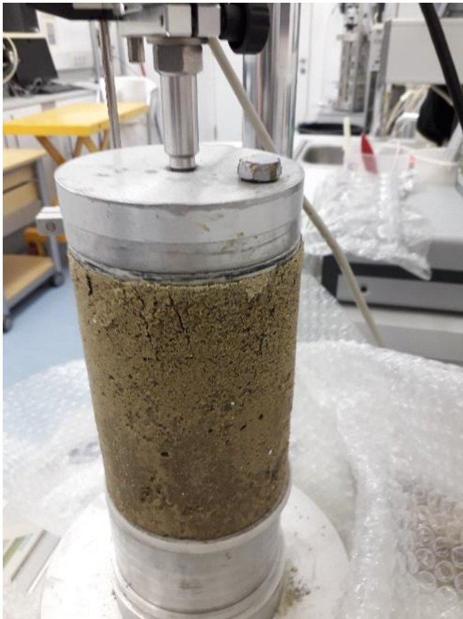
Abb. 10: gebrochene Probe (Probenalter: 7 Tage)
