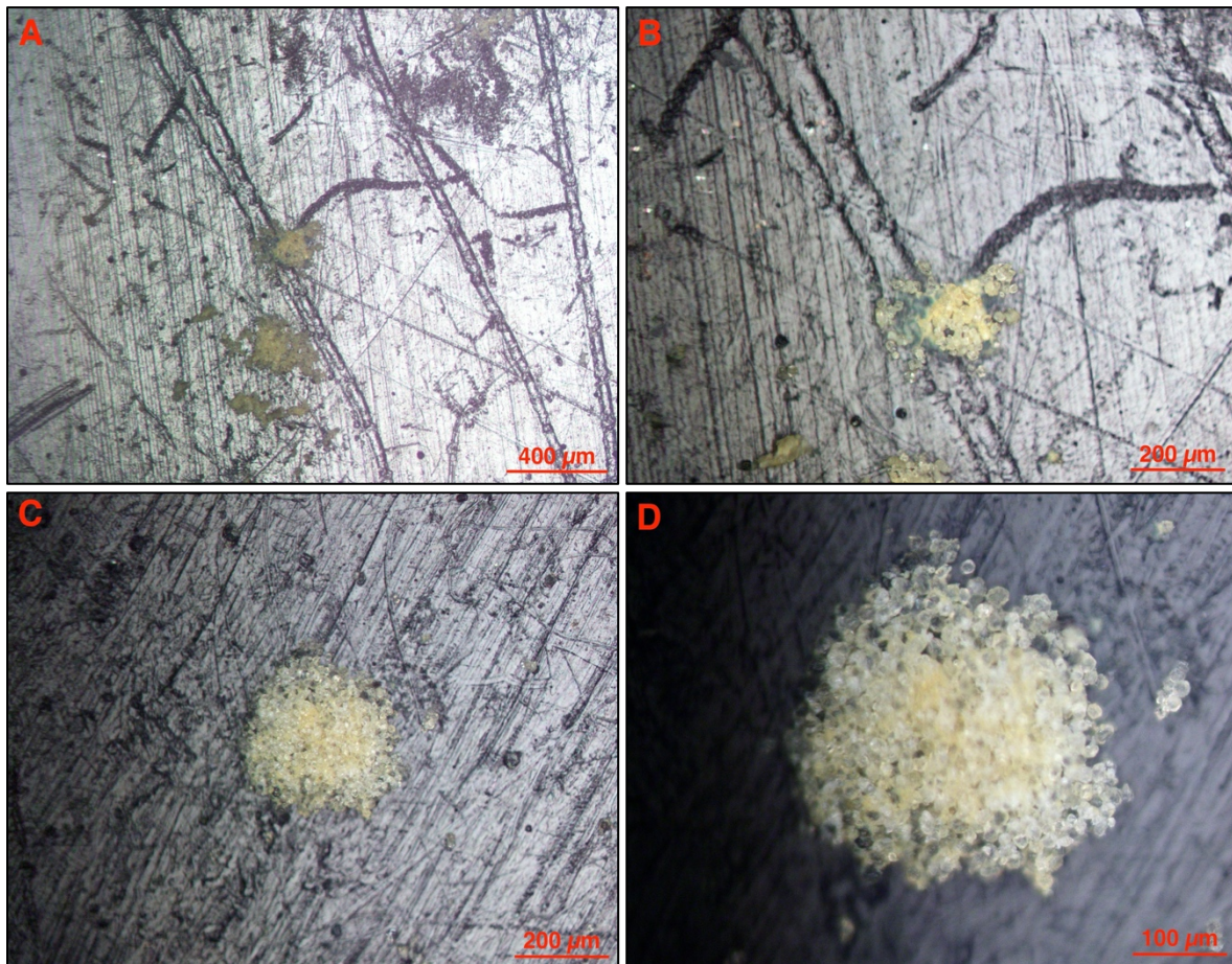
Abbildung 32: Präzipitate auf einem Polyethylen (PE) Kunststoffsubstrat aus der Kontrolllösung (ohne Inhibitor); (A) (50-fache Vergrößerung) und (B) (100-fache Vergrößerung) Agglomeration von Kalziten mit möglicher Zementierung; (C) (10-fache Vergrößerung) und (D) (200-fache Vergrößerung) dichte Agglomeration von Kalziten.
