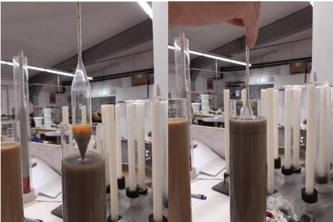
**Abb. 18:** Eintauchen des Aräometers in die Suspension (Foto: R. Albrecht)
