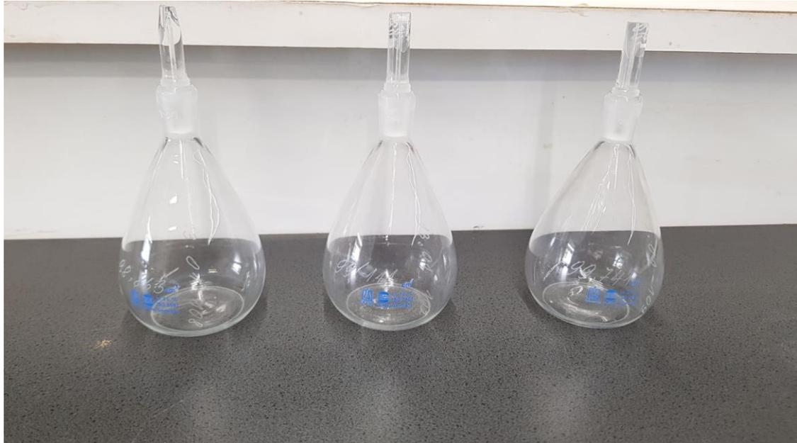
**Abb. 11:** Kapillarpyknometer mit Stöpsel (Foto: R. Albrecht)
