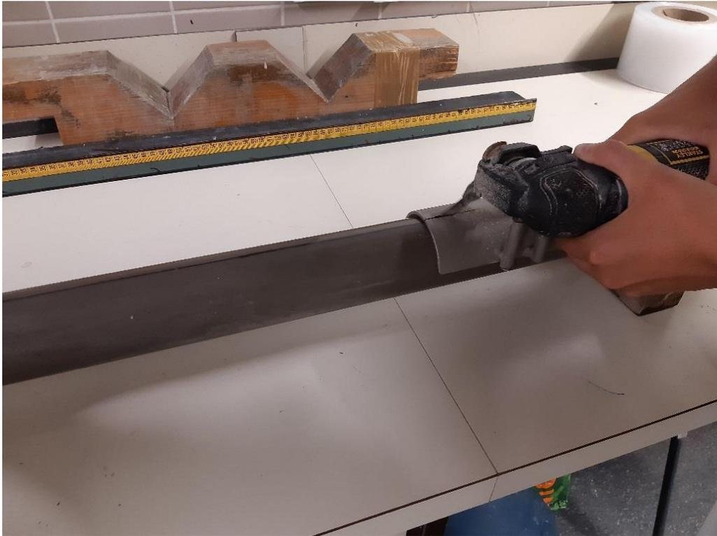
**Abb. 37:** Öffnen der Kerne mit Hilfe einer Schneidemaschine (Foto R. Albrecht)
