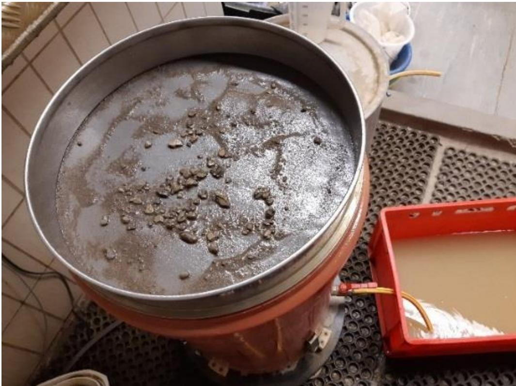
**Abb. 15:** Durchspülung durch ein Sieb mit der Maschenweite von 0,125 mm (Foto: R. Albrecht)
