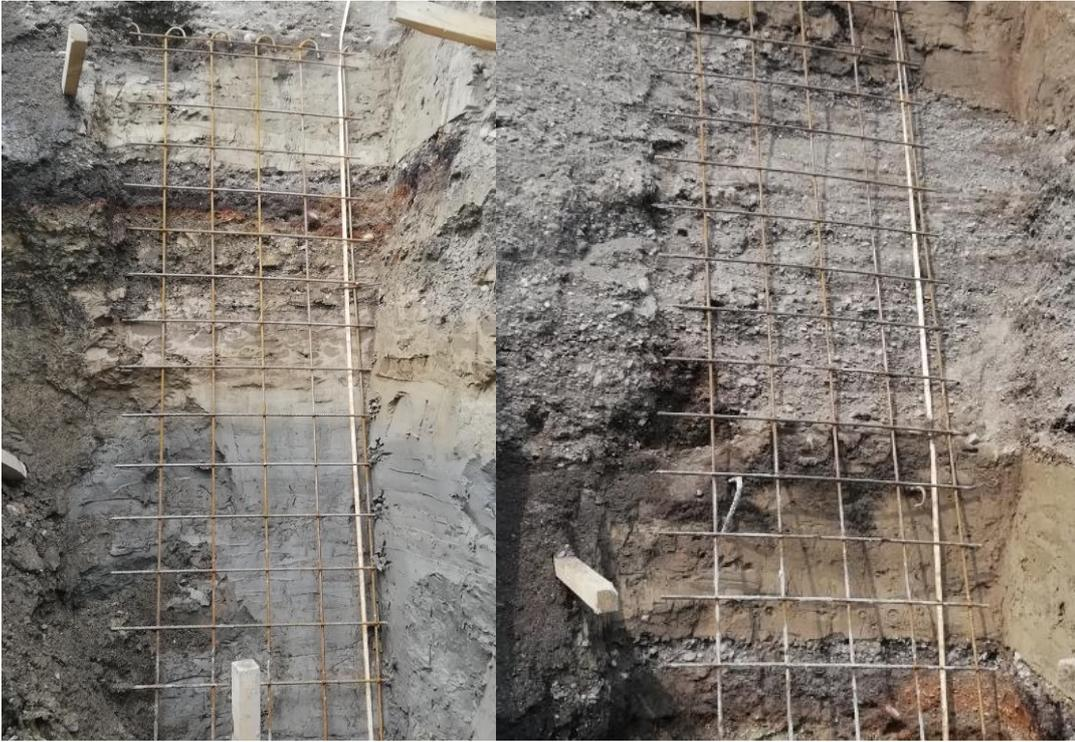
**Abb. 45:** Raster für die TinyPerm Messung (links: unterer Bereich, rechts: oberer Bereich)
