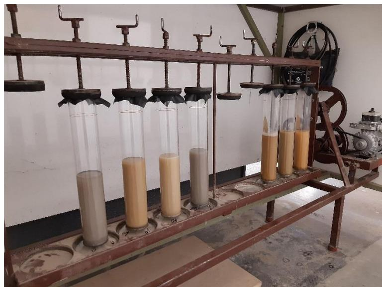
**Abb. 17:** Mischgerät mit eingespannten Messzylindern
