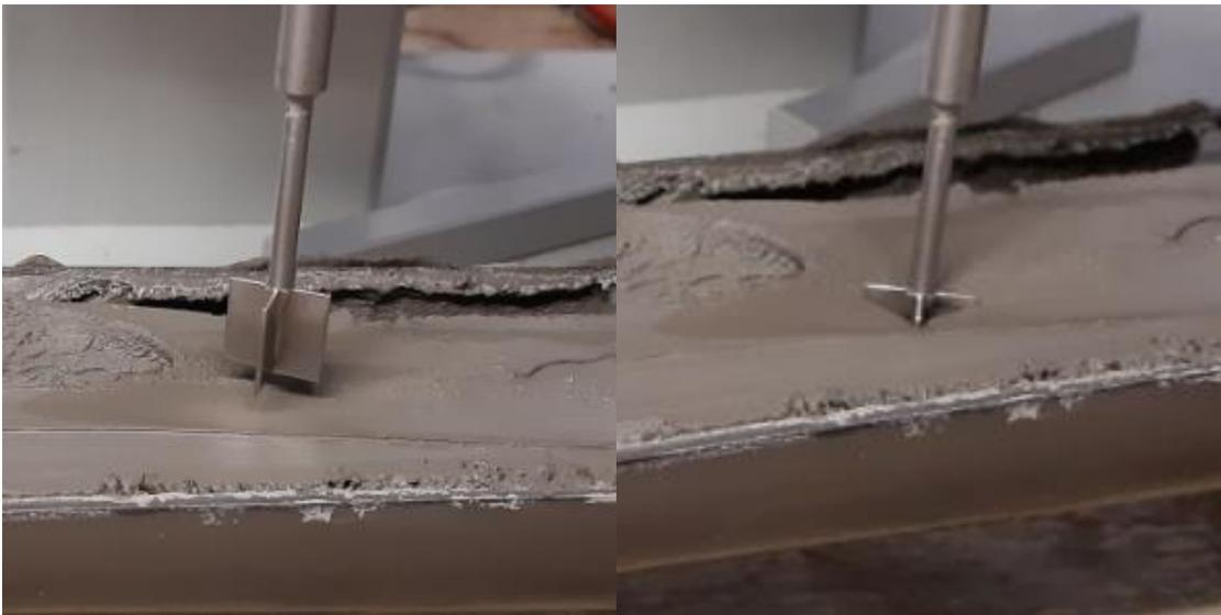
**Abb. 40:** Drehflügelsonde vor und beim Einführen in das Sediment (Foto R. Albrecht)
