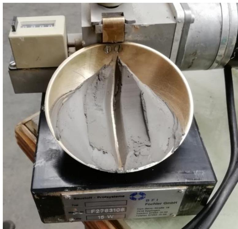
**Abb. 25:** Fließgrenzengerät nach Casagrande mit Probenmaterial und Furche (Foto: R. Albrecht)
