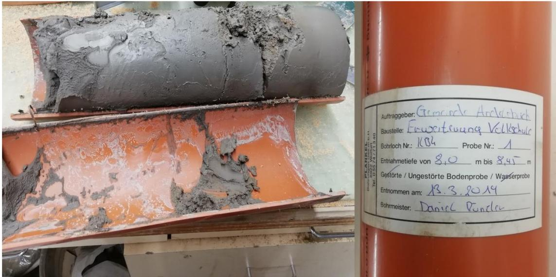
**Abb. 10:** Geöffneter Bohrkern der Kernbohrung 4 (Foto: R. Albrecht)
