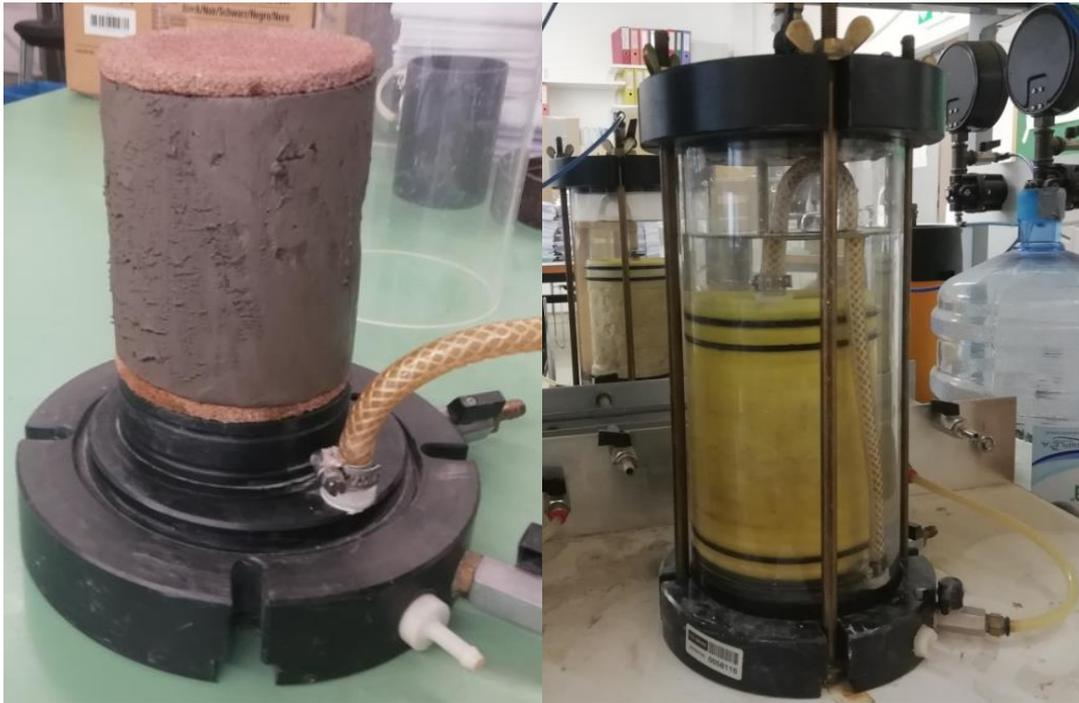
**Abb. 30:** Probe mit Filtersteinen und eingebaute Probe in der mit Wasser gefüllten Triaxialzelle (Fotos: R. Albrecht)
