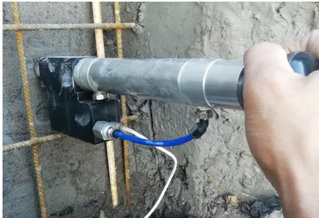
**Abb. 44:** Messung mit dem TinyPerm (Foto R. Albrecht)
