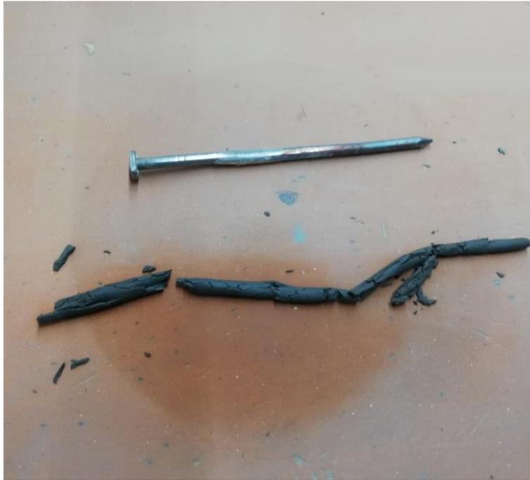
**Abb. 26:** Ausrolltest auf Tonplatte (Foto: R. Albrecht)
