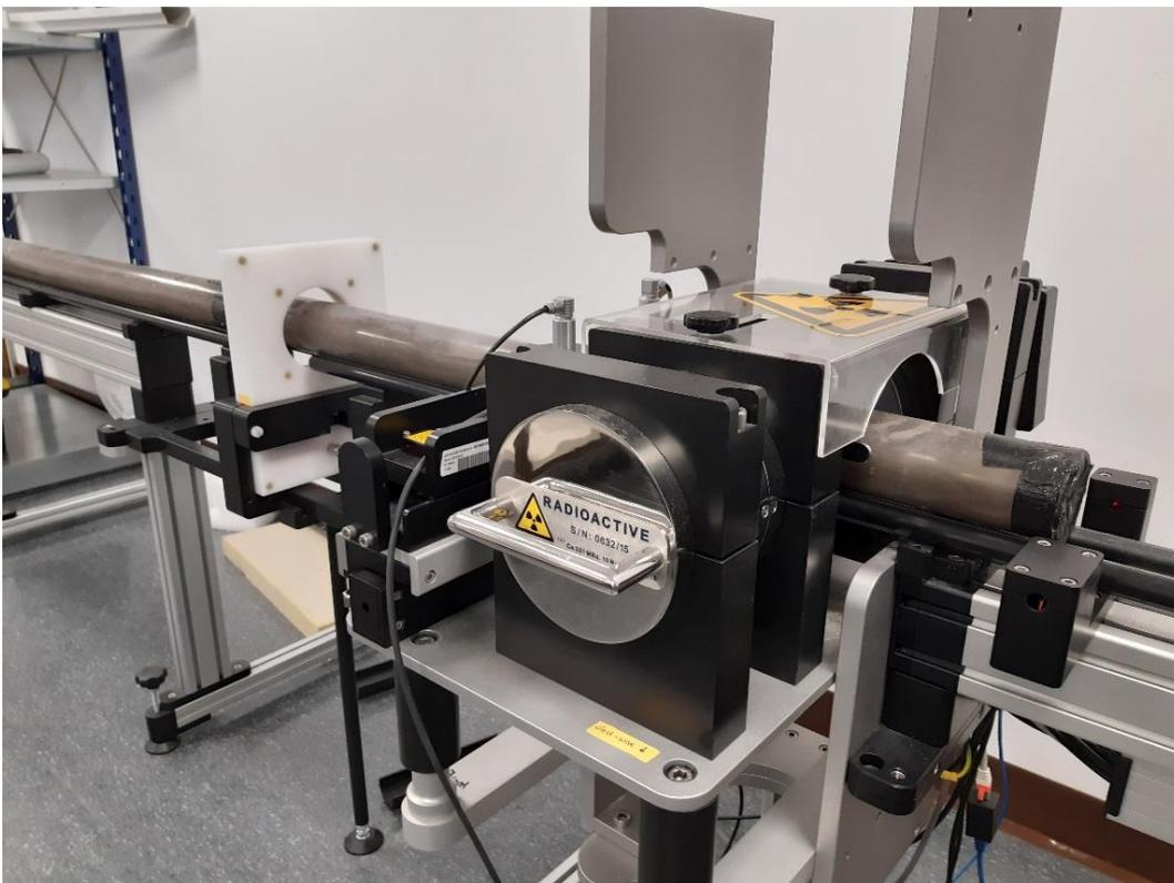
**Abb. 35:** Multi Sensor Core Logger (Foto R. Albrecht)
