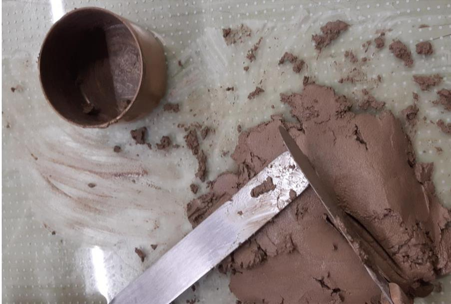
**Abb. 23:** Anmischen der Proben und Fallkegel mit Probenbehälter und Probe (Foto: R. Albrecht)
