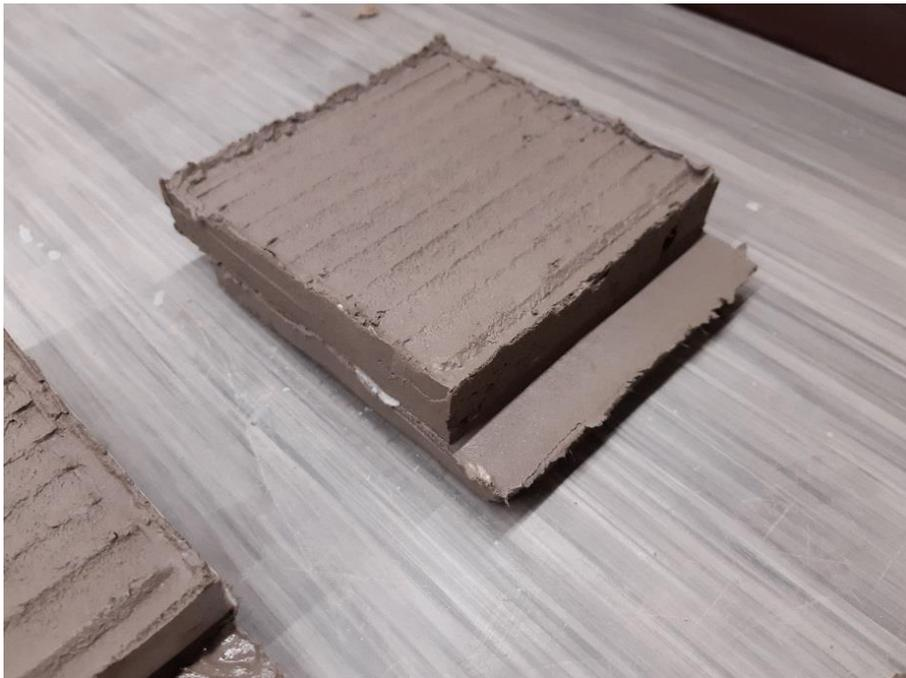
**Abb. 48:** Probe nach dem Ausbau aus der Scherbüchse (Foto R. Albrecht)
