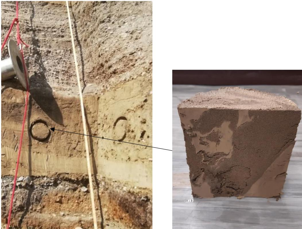
**Abb. 50:** Stechzylinderentnahme; Probe 6a (Fotos R. Albrecht)
