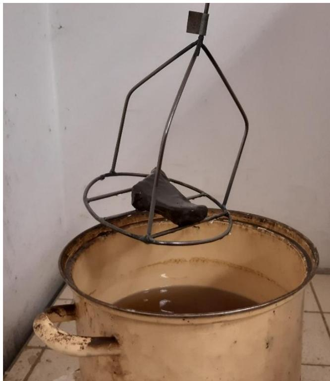
**Abb. 13:** Drahtkorb und Probenkörper nach dem Eintauchen in das heiße Wachs (Foto: R. Albrecht)
