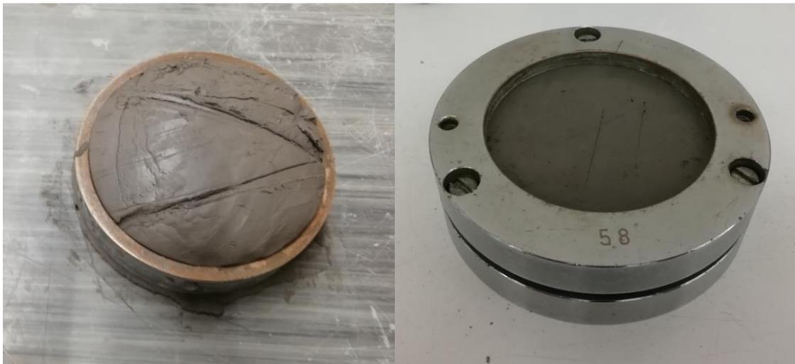
**Abb. 31:** Ausstechring und Haltering mit Probenmaterial (Fotos R. Albrecht)
