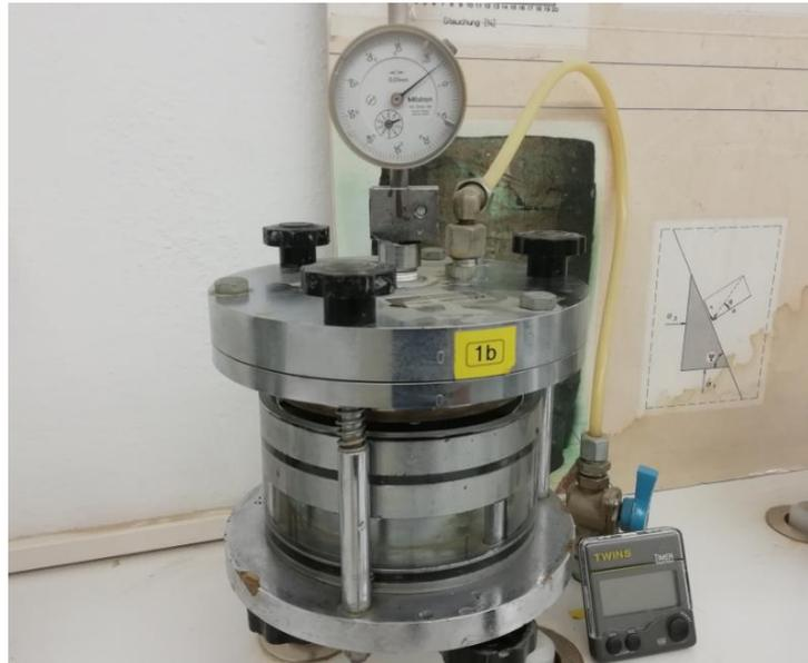
**Abb. 32:** Versuchsgerät für den Oedometertest (Foto R. Albrecht)
