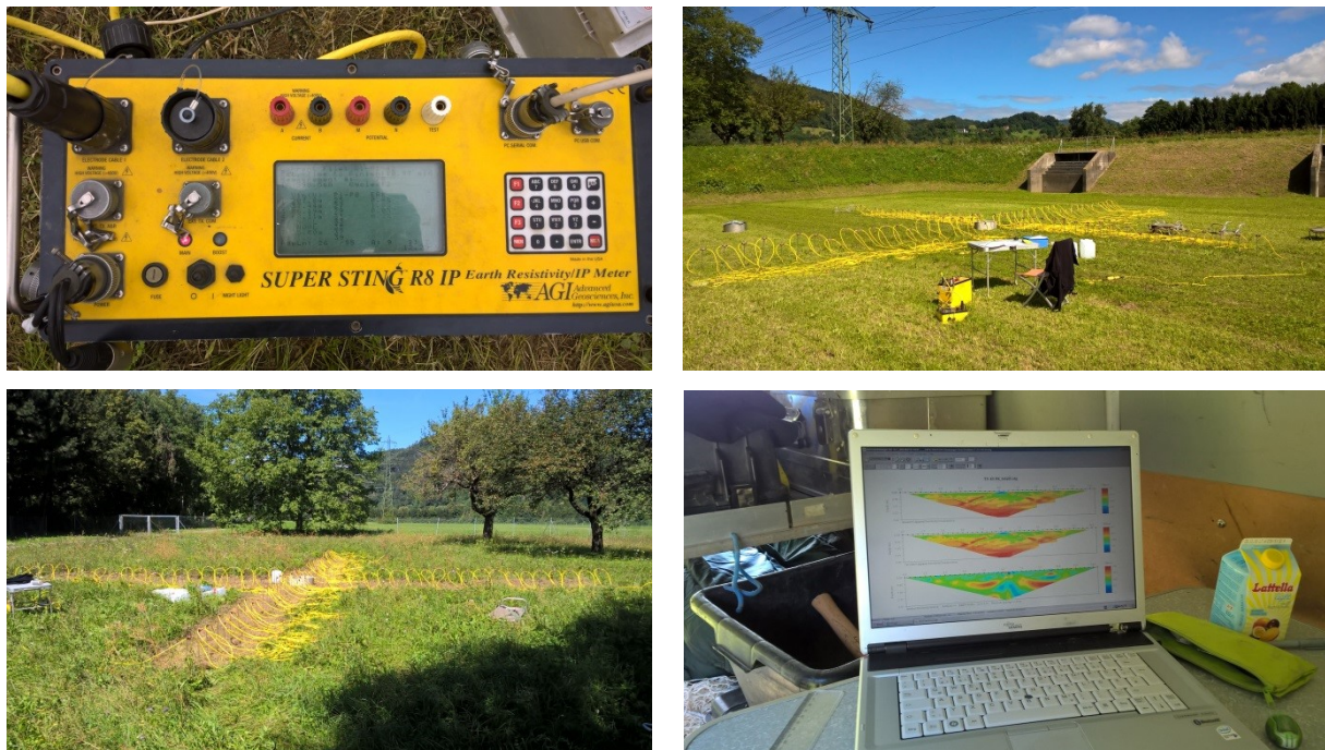
Abbildung 11: Geoelektrik: Messgeräte und Aufbau, links oben: Elektrischer Widerstandsmeter, rechts oben: Aufbau der Geoelektrik im Feld A mit Ringinfiltrometer im Zentrum, links unten: Aufbau der Geoelektrik im Feld B mit Ringinfiltrometer im Zentrum, rechts unten: PC-Auswertung vor Ort.
