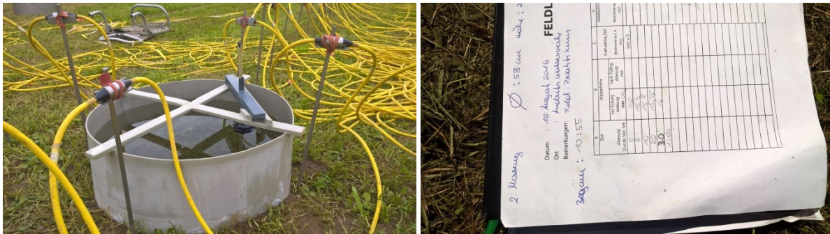
Abbildung 4: Ringinfiltrometer: links, Ring befüllt mit Wasser und Messskala, Anbindung der Metallspieße mit Swift-Kabeln, rechts Dokumentation des Wasserstandes mit bestimmten Zeitintervall.
