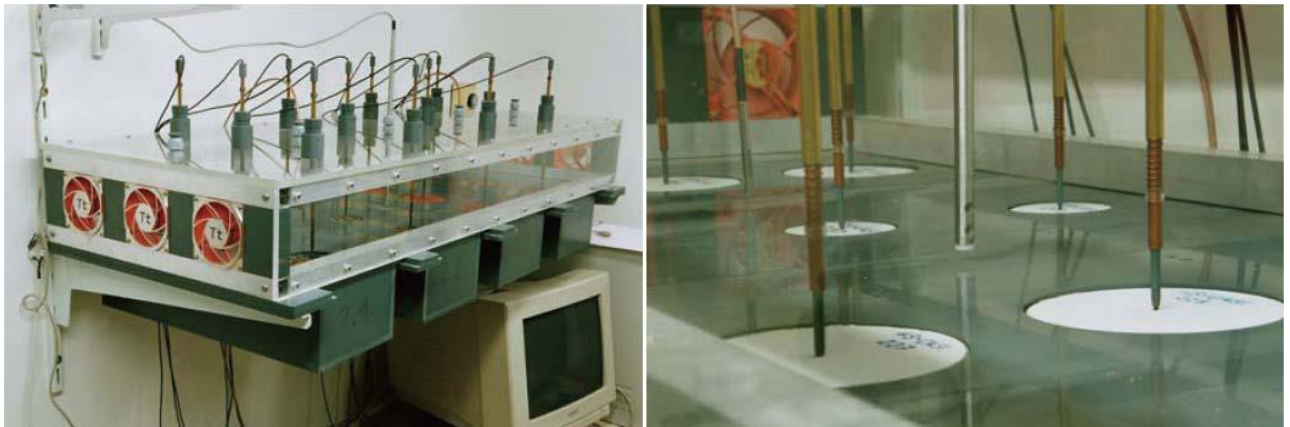
Bild 41 Verdunstungsapparatur zur kontinuierlichen Bestimmung der Trocknungsgeschwindigkeit (aus Scheffler (2008) )
