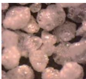
Bild 24 Thermosilit-Körner im CalceClima® Thermo Kalk-Wärmedämmputz (Röfix (2019))
