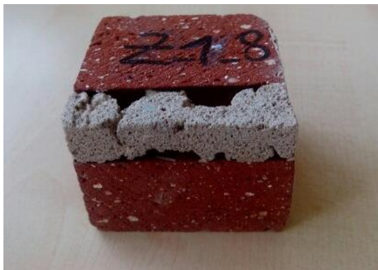
Bild 109 Mauerwerksprobekörper aus einem Gebäude mit teilweise gefüllter Mörtelfuge
