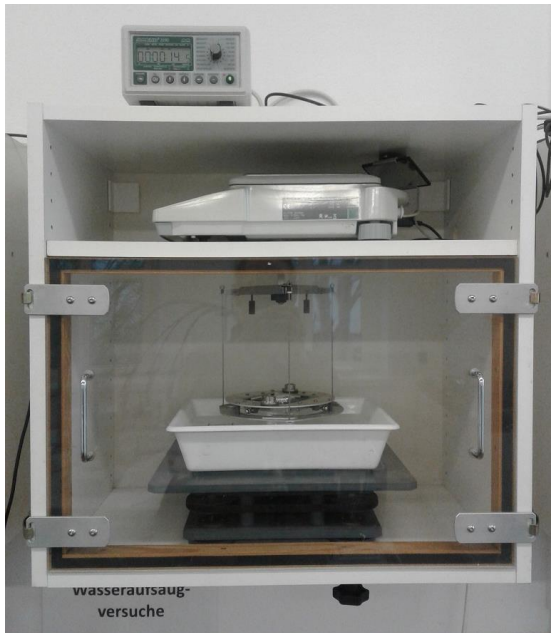
Bild 39 Messapparatur zur kontinuierlichen Messung der Wasseraufnahme
