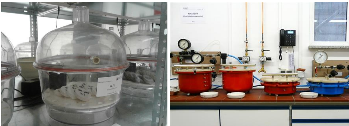
Bild 36 Links Exsikkatoren zur Bestimmung der hygroskopischen Sorptionsisotherme; rechts Druckplattenapparaturen zur Bestimmung der Wasserretention
