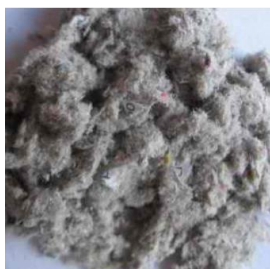
Bild 22 Zelluloseflocken, Grundlage für die Aufspritz-Zellulose (Quelle: Renocell/Isocell GmbH)
