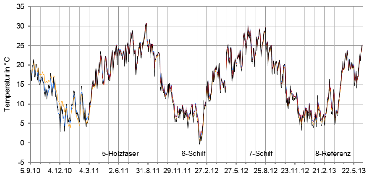
Bild 67 Temperaturen in den Balkenauflägern in Stirnholznähe an Balken 5-8 (gemittelte Tageswerte)
