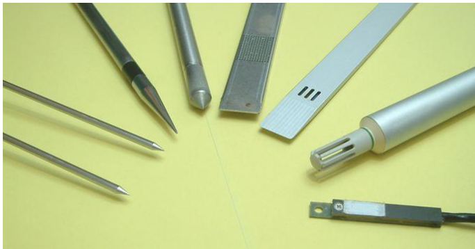
Bild 12 Spezielle Sensoren zur Holzfeuchtemessung (1.+ 2. von links) und für die Luftfeuchte- und Temperaturmessung (Foto: Schaller GmbH)
