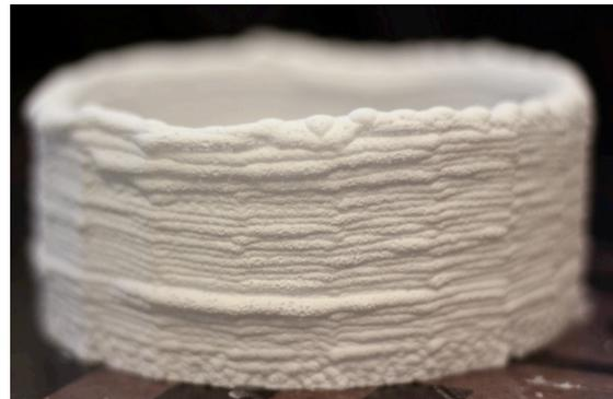
**Abbildung 2: Raupenförmige Oberfläche,**
