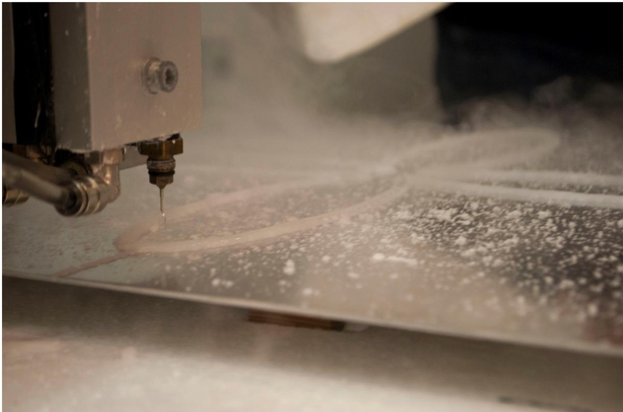
**Abbildung 69: Materialauftrag mit Stickstoffkühlung, Quelle: Eigene Darstellung.**
