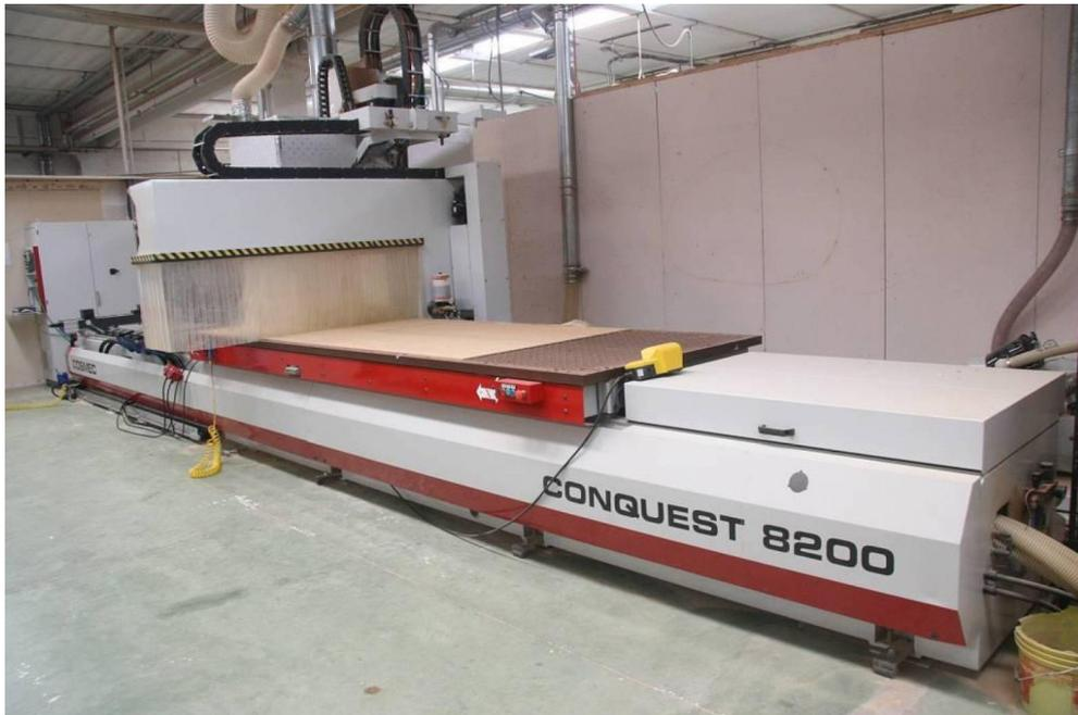
Abbildung 38: 5-Fräsmaschine, Quelle: Höchsmann (2019)
