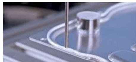
**Abbildung 25: Raupenförmiger Fluidauftrag,**
