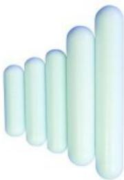
**Abbildung 27: Magnetrührstäbchen, Quelle: bartelt (2019).**
