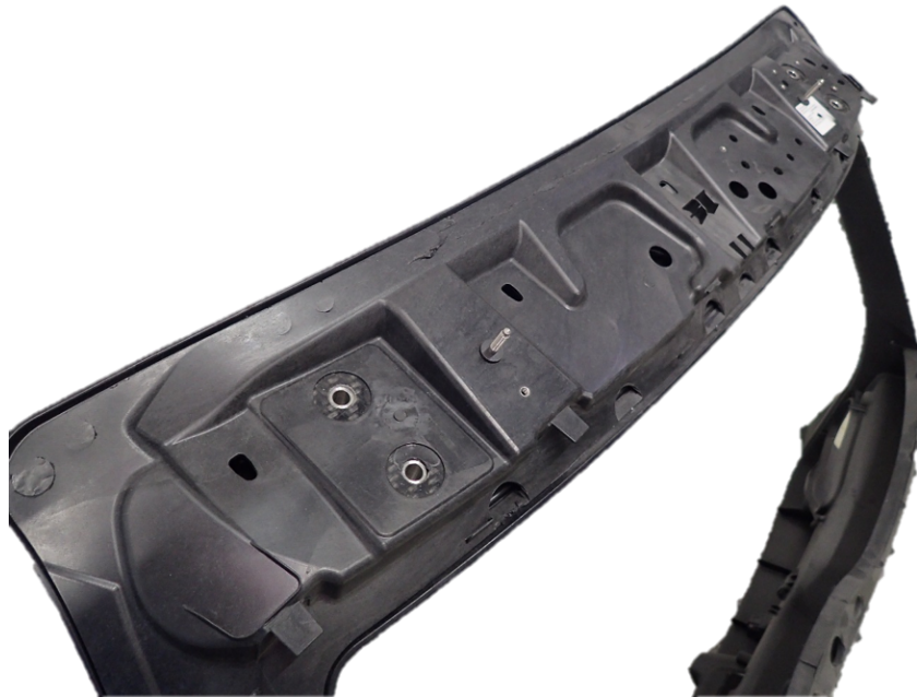
Abbildung 7.3: Schweißnaht am HKL Deckel oben.
