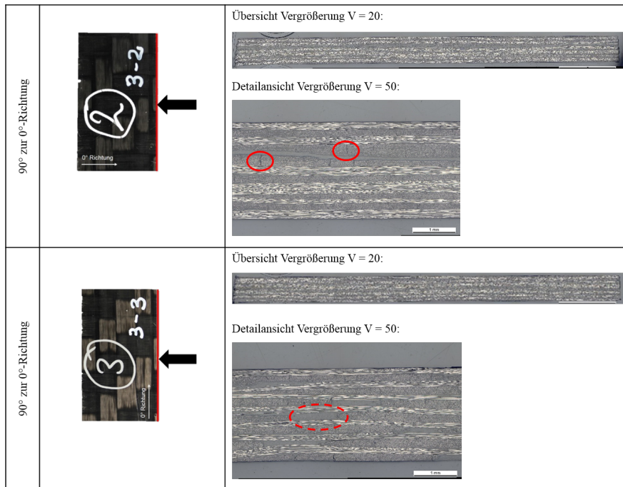
Abbildung 6.10: Mikroskopaufnahmen des Versuchswerkstoffes PA66-CF Körperbindung mit Anmerkungen zu den Werkstoffunregelmäßigkeiten bereits vor den Schweißversuchen: Oben: Mit Kreisen markierte Risse in den Faserrovings. Unten: Mit strichliertem Kreis markierte Anhäufung von Matrixwerkstoff.
