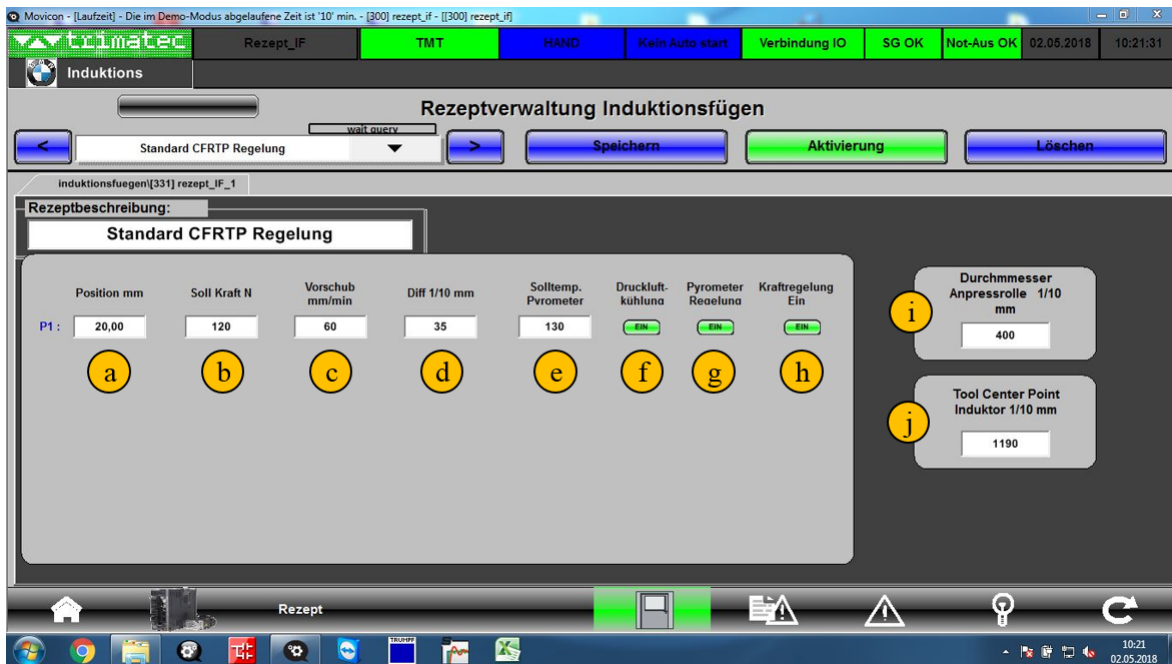
Abbildung A.39: Schweißrezept und Eingabemöglichkeiten in der Schweißsteuerung.
