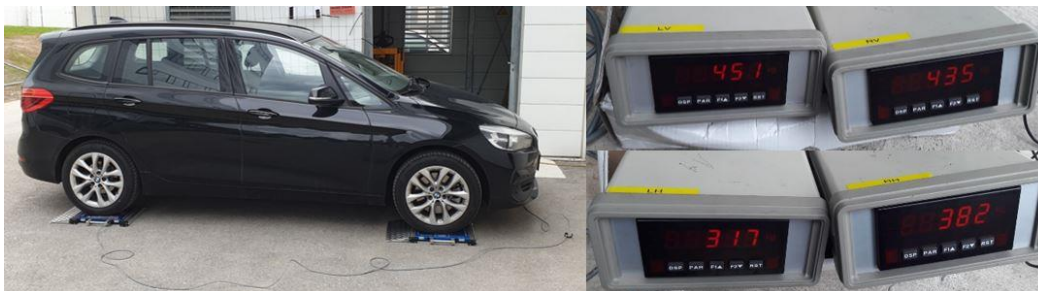
Abbildung 4-13 Fahrzeugmassenmessung mit Wiegezellen
