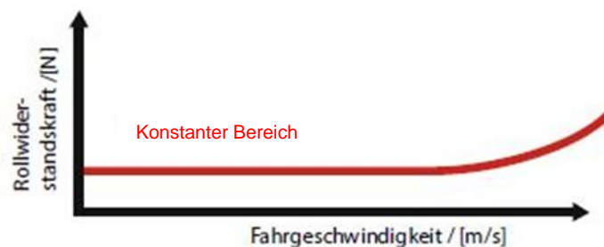
Abbildung 2-2 Rollwiderstand in Abhängigkeit der Geschwindigkeit [2]
