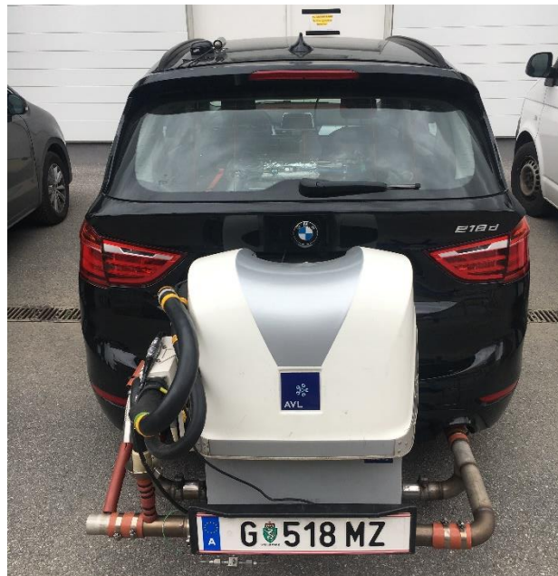
Abbildung 4-9 PEMS auf der Anhängerkupplung
