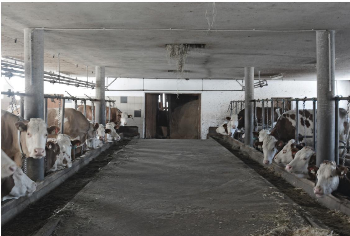
Abbildung 51: Im Erdgeschoss des Stalles werden die Kühe aktuell in Anbindehaltung gehalten. Sie stehen oder liegen dabei, an einer Kette fixiert, auf ihrem Platz. Vor den Kühen ist der Futtertisch mit Futterbarn. Darüberliegend sind die Abwurföffnungen für das Heu aus dem ersten Obergeschoss positioniert. Die Anbindehaltung wird heute oftmals von der Freilaufhaltung abgelöst.
