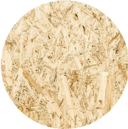
**Abb. 35:** OSB-Platten für den Sanitärblock
