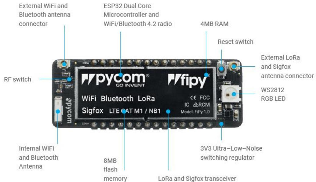
Abbildung 4-20: Pycom FyPy Mikrokontroller (Pycom, 2019)
