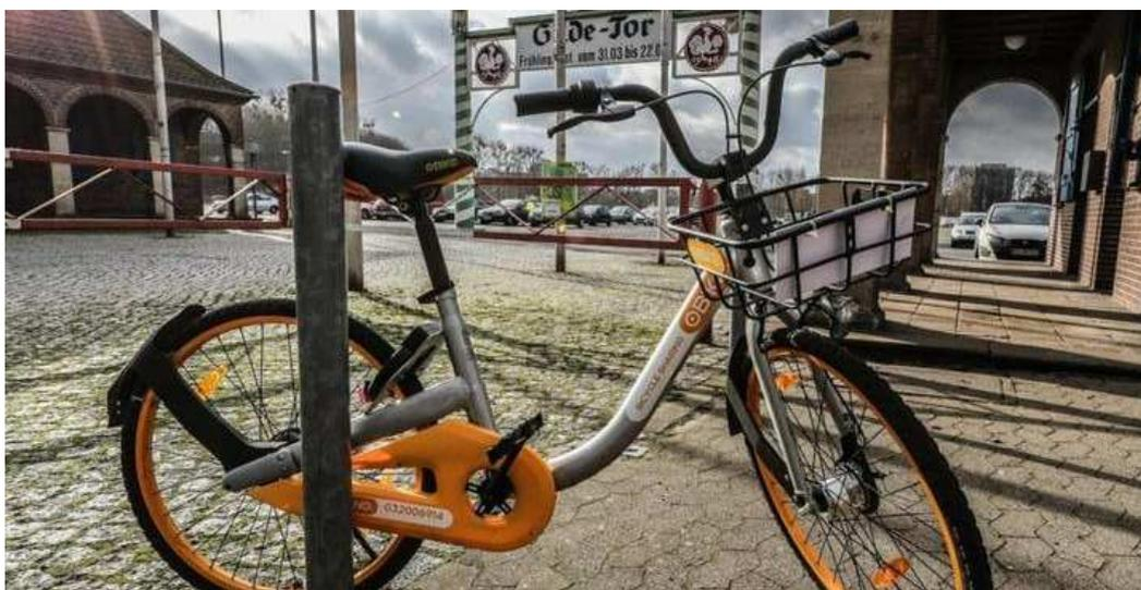
**Abbildung 76: Mögliche Ausführung mit Hinterradschloss (Rainer Droese, 2018)**
