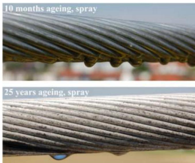
Bild 5.3.1: Vergleich der Tropfenbildung zweier Leiterseile aus Süddeutschland [39]
