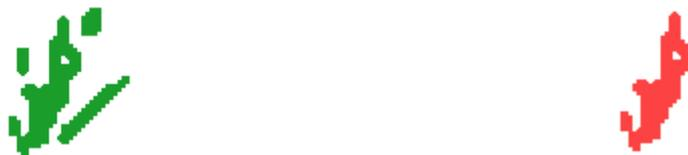
**Abbildung 7-8: Eingefärbtes Binärbild einer Pflanze (links ohne „Blob reduction“, rechts mit)**
