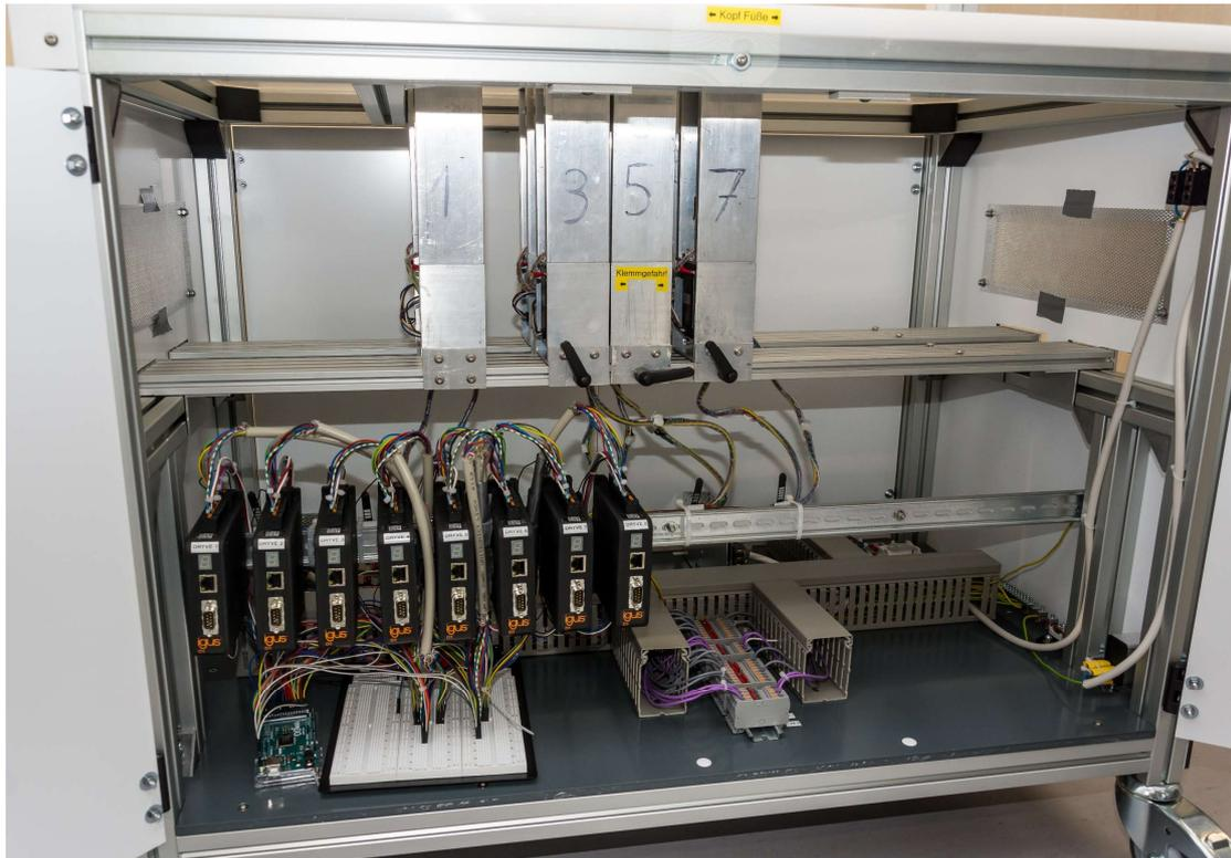
Abbildung 29: Technikebene und Schienensystem des Therapiegerätes
