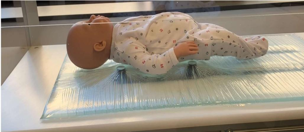
*Abbildung 30: Lage des Patienten bei ausgefahrenen Hubsäulen der Sequenz SR-GR*
