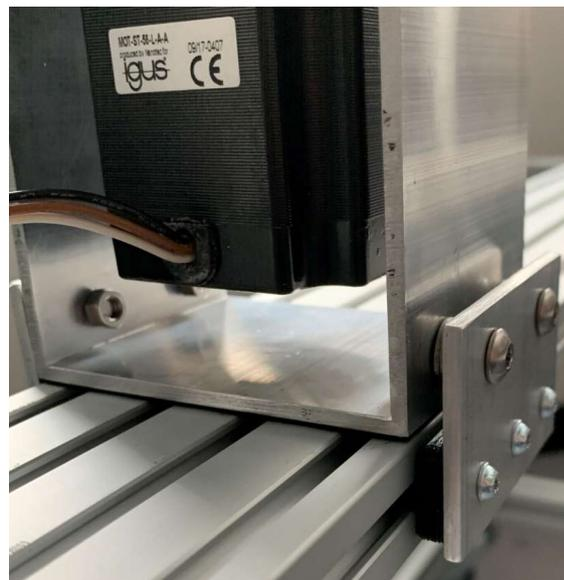
Abbildung 27: Führung mit dem Profilgleiter
