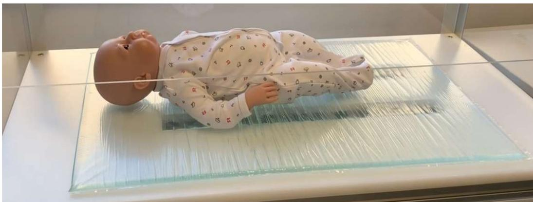
Abbildung 21: Versuchsaufbau mit der Muster-Gelmatte und der Therapiepuppe
