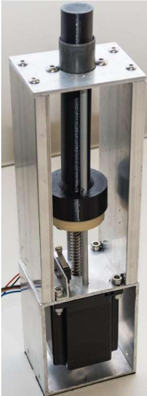
Abbildung 26: Angefertigte Hubsäule ohne Halterung
