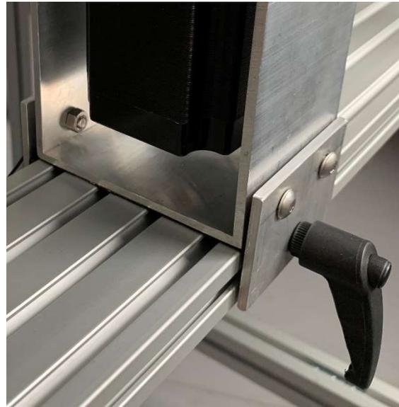
Abbildung 25: Befestigung der Hubsäule mittels Klemmhebel
