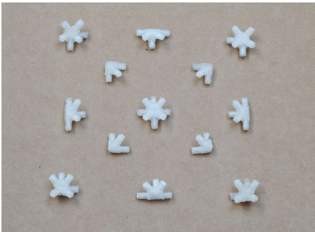
Abb. 3.173. 3-D-gedruckter Knotensatz eines Raumfachwerks
