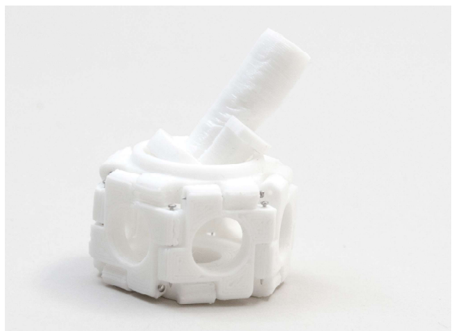
Abb. 3.30. Scharnierknoten, Anschlusselement mit Federverriegelung, gelenkig
