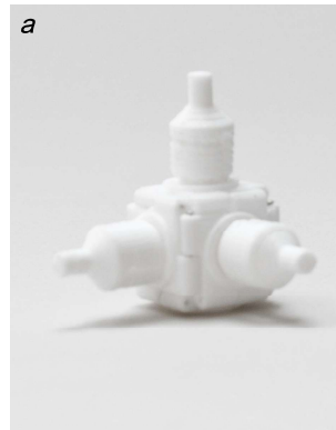
Abb. 3.26. Scharnierknoten mit orthogonalen (a) und gelenkigen (b) Anchlusselementen
