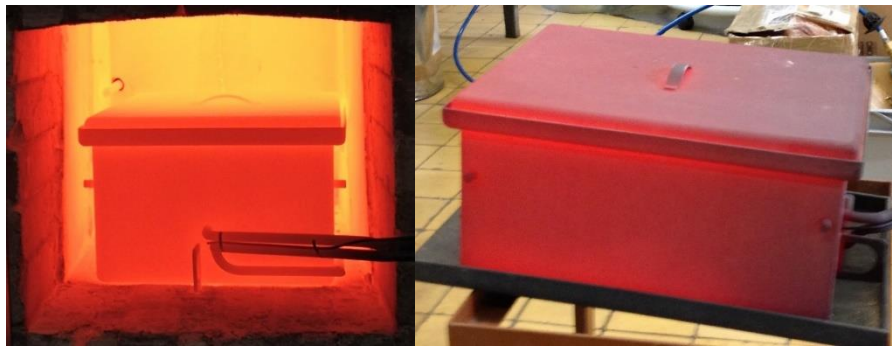
Abbildung 28: Foto der erhitzten Wärmebehandlungskammer. Es soll auf mögliche Temperatur-Inhomogenitäten hingewiesen werden.
