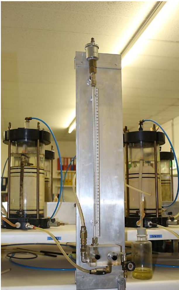
Abb. 44: Vorrichtung zur Messung kleinste Wasservolumen
