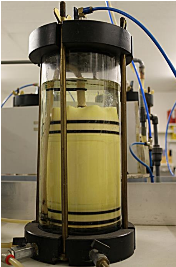
Abb. 35: Triaxialzelle für Durchlässigkeitsuntersuchung
