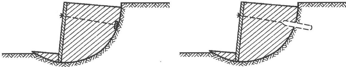
Fig. 22: Loss of overall capacity for a single anchored wall (Deutsche Gesellschaft für Geotechnik e.V., 2012)
