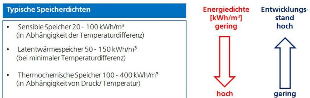
Abbildung 34: Vergleich der Wärmespeicher bezüglich der Energiedichte [43]
