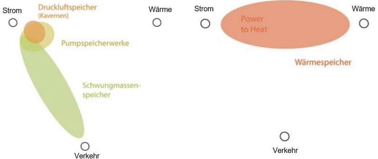
**Abbildung 36: Sektorale Anwendungsmöglichkeiten von mechanischen (links) und thermischen (rechts) Energiespeichern [10]**
