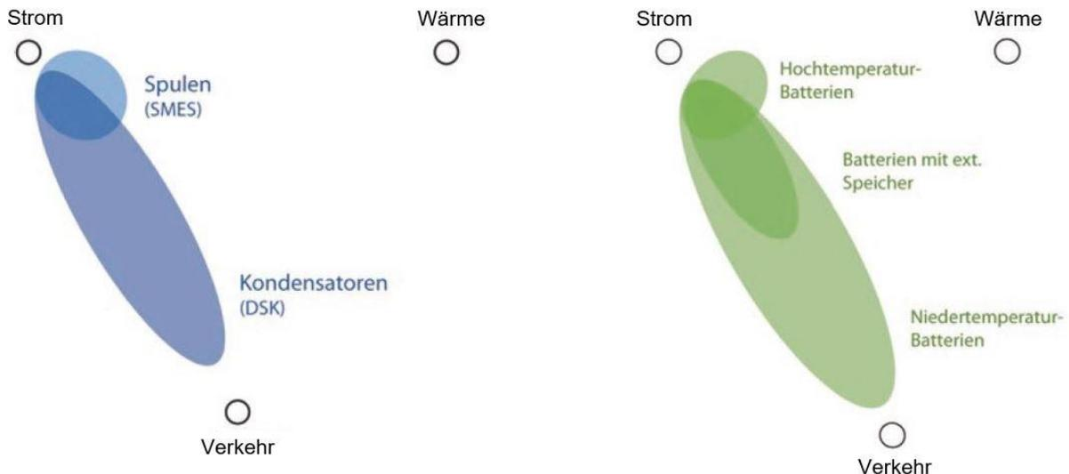
**Abbildung 35: Sektorale Anwendungsmöglichkeiten von elektrischen (links) und elektrochemischen (rechts) Speichern [10]**
