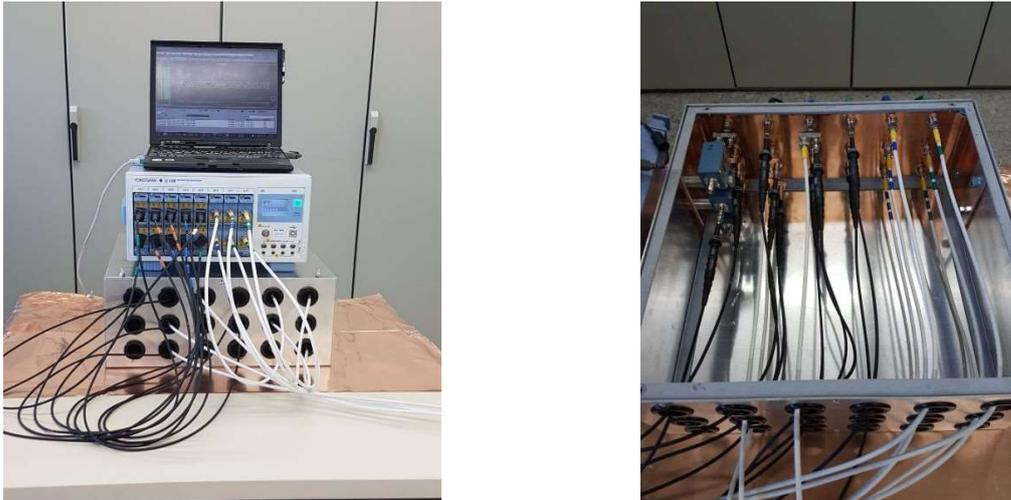
Abbildung 5-4: Links: Messtechnik zur Erfassung von transienten Spannungen in Hochspannungsanlagen vor Ort
