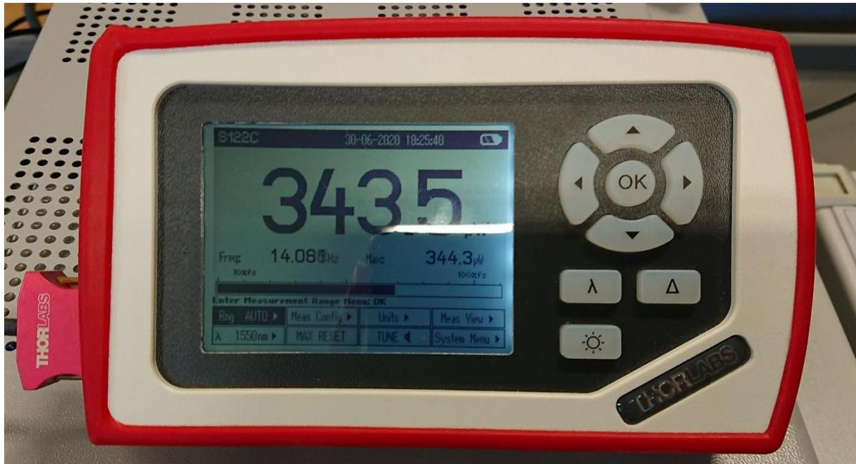
Anzeige des optischen Leistungsmessgeräts: Leistung am Ausgang des SFP-Moduls nach Einfügen eines Dämpfungsgliedes
