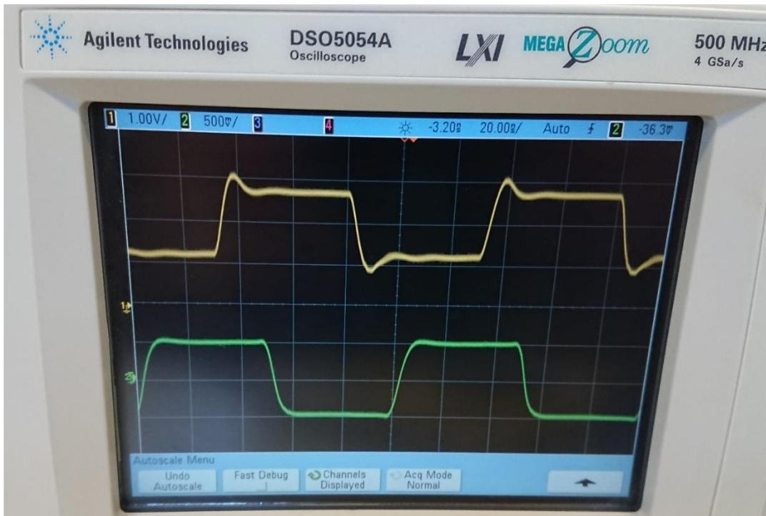
Abbildung 4.8: Ausgangssignal der Schaltung bei 10 MHz Eingangssignal
