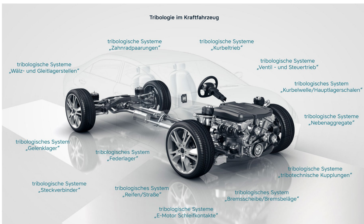
Abbildung 2: Beispiele tribologischer Systeme im Kraftfahrzeug [vgl. 10]
