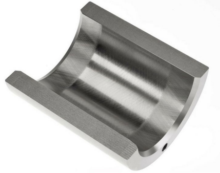
Abbildung 7: Oberflächenstruktur einer Streifenhonung [30]
