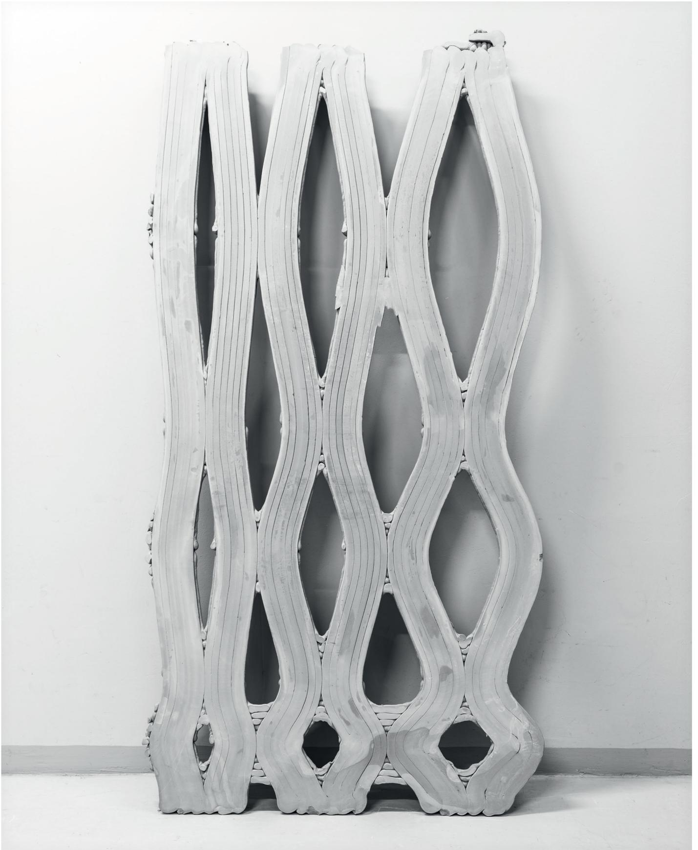
Bild 104. Parametrisierte Anwendung des Druckpatterns Welle auf einen Baukörper
