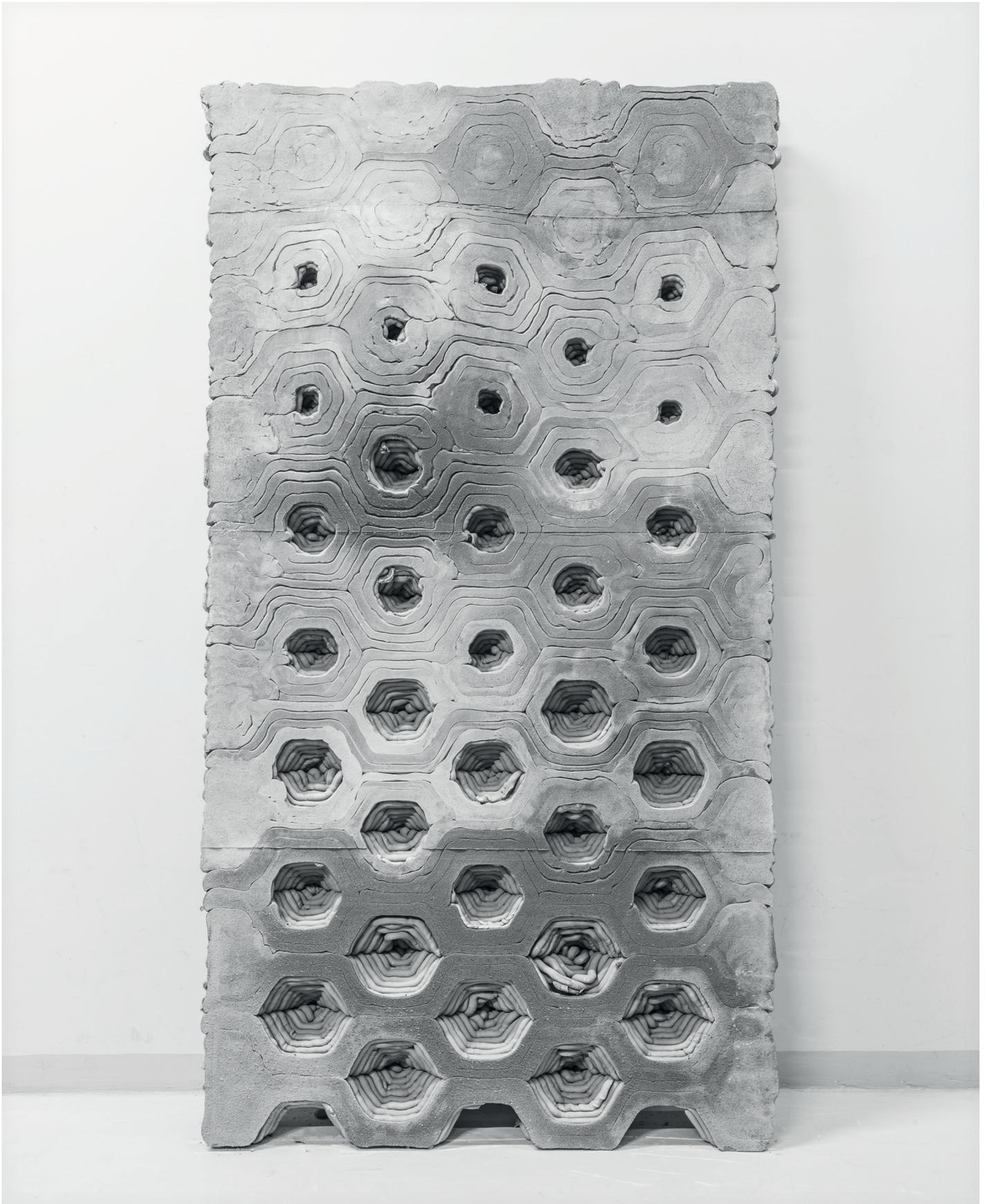
Bild 113. Parametrisierte Anwendung Druckpattern Hexagon auf einen Baukörper
