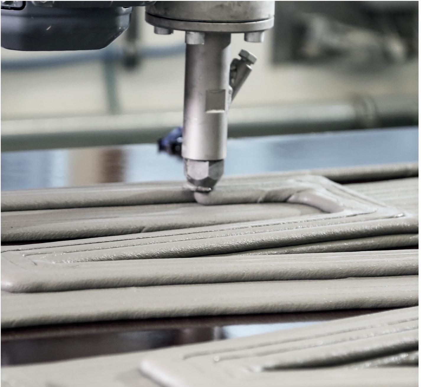
Die geometrischen Möglichkeiten des 3DCP sind bisweilen noch nicht systematisch festgehalten und katalogisiert. Daher wurden im Rahmen dieser Arbeit quadratische Musterstücke entworfen und mittels manuell erstellter Druckpfade im Horizontaldruck gefertigt. Sie erforschen die Möglichkeiten des Verfahrens hinsichtlich plattenförmiger Geometrien. Diese verschiedenen Designs sind frei kombinierbar und in folgende Gruppen klassifiziert:
