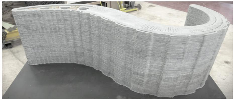
Der Prozess des Concrete Printing ähnelt dem, des auf der Vorseite erläuterten Contour Crafting und wird als Fused Deposition Modeling (FDM), oder als Fused Layer Modeling/Manufacturing (FLM) bezeichnet. Als Druckmaterial wird ein faserverstärktes Betongemisch herangezogen, welches unmittelbar vor dem Drucken hergestellt und in einem Behälter gelagert wird.<sup>10</sup> Unter diesem Behälter befindet sich eine Düse mit 9mm Durchmesser, durch wel-
