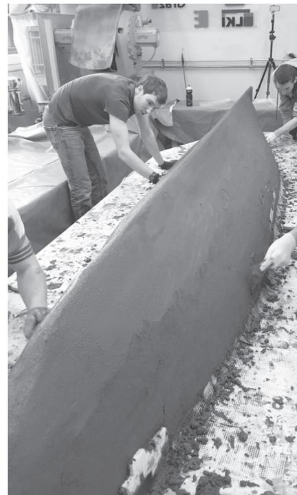
Das für die Betonkanuregatta 2017 gefertigte Kanu der TU Graz wurde durch 3DCP hergestellt. Dabei wurde die Geometrie des Kanus um 180° gedreht, und somit mit der Oberkante des Rumpfes nach unten gefertigt. Beim Druckprozess selbst wurde das Druckteil mit Sand unterstützt, welcher in den entstehenden Hohlkörper schrittweise eingefüllt wurde.
