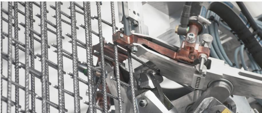
Der zweite Teil des Mesh Mould Projektes, welcher sich auf die gewonnenen Erfahrungen in der Erstellung von Gitterstrukturen des ersten Teils stützt, setzt seinen Fokus auf die Aktivierung des hergestellten Gitters. Daher werden dabei die Polymerfilamente durch Stahlstäbe ersetzt.<sup>23</sup>
