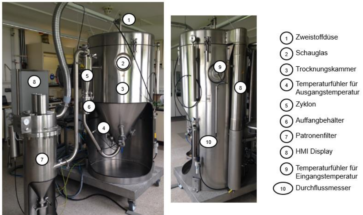
Abb. 3-4 Aufbau der verwendeten Sprühtrocknungsanlage Mobile Minor™
