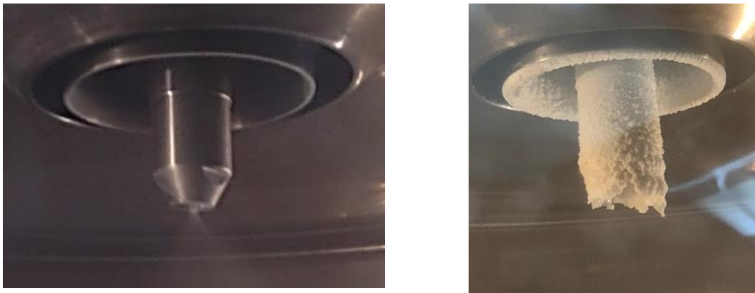
Abb. 4-8 links Düse beim Start des Versuchspunktes rechts: Verkrustung nach einem Versuchspunkt
