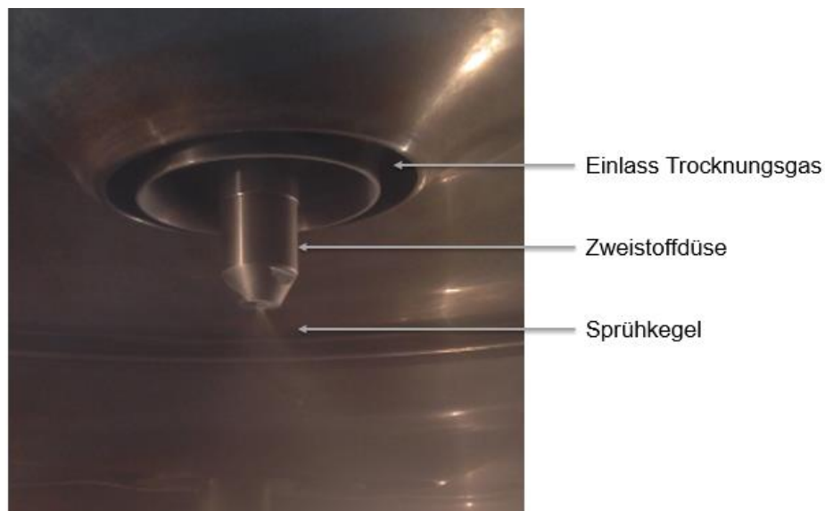
Abb. 3-3 Zweistoffdüse während des Sprühtrocknungsprozesses mit entstandenem Sprühkegel
