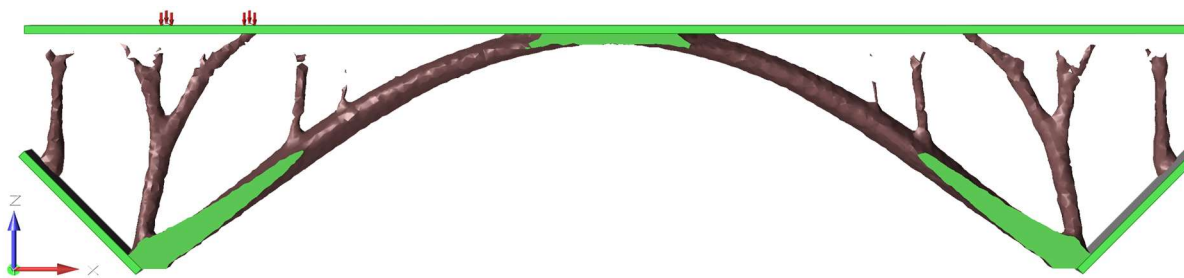
Abb. 40 3D-Brücke Schnitt Randstruktur (Grün = Schnittfläche)
