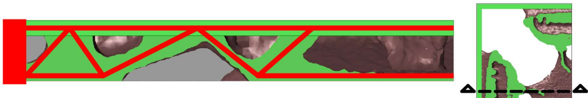
Abb. 65 Schnitt der 40 cm Decke auf Wänden aus solidThinking Inspire mit überlagertem abstrahiertem Fachwerkmodell in Rot
