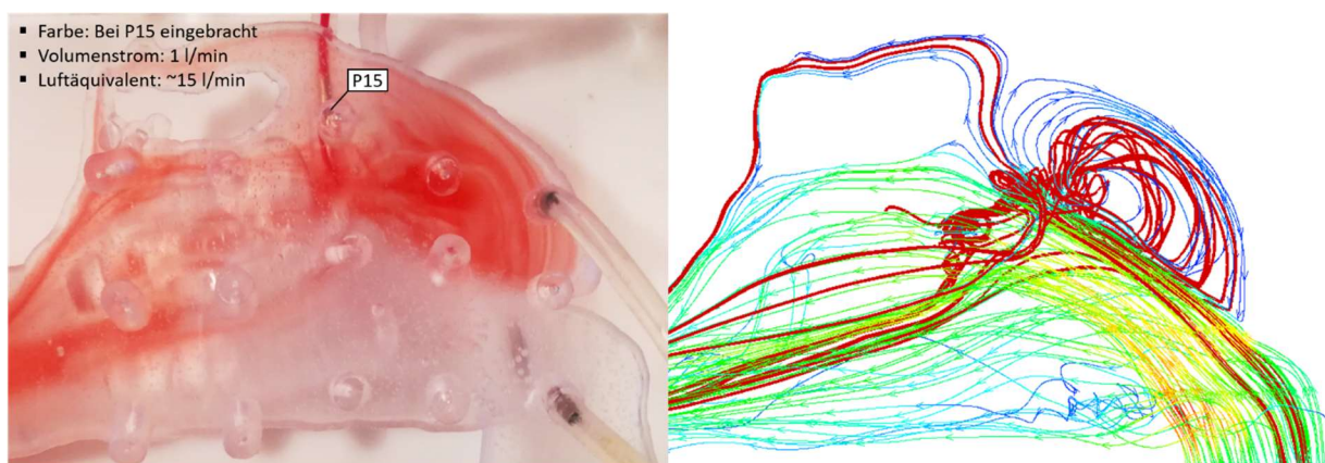
Abbildung 33: Experimentelle Visualisierung (links) und CFD-Rechenergebnisse (rechts); die Farbe wird an Punkt P15 eingebracht und mit den Stromlinien in diesem Bereich verglichen.
