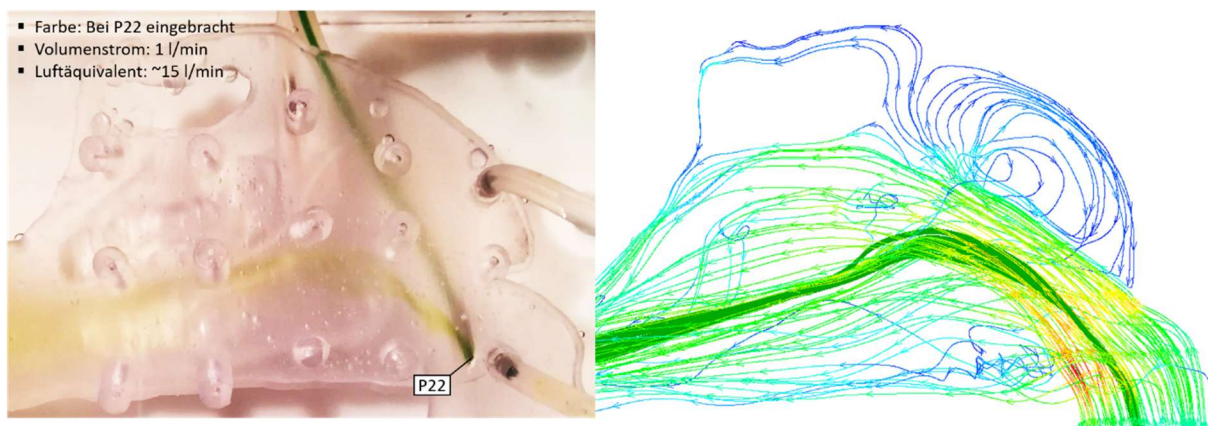
Abbildung 36: Experimentelle Visualisierung (links) und CFD-Rechenergebnisse (rechts); die grüne Farbe wird an Punkt P22 eingebracht und mit den Stromlinien in diesem Bereich verglichen.
