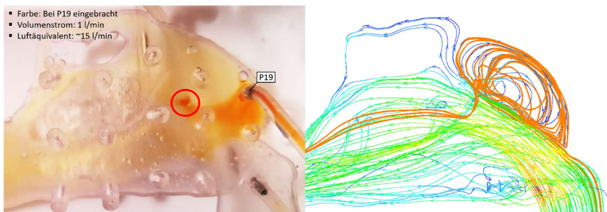
Abbildung 34: Experimentelle Visualisierung (links) und CFD-Rechenergebnisse (rechts); die gelbe Farbe wird an Punkt P19 eingebracht und mit den Stromlinien in diesem Bereich verglichen.
