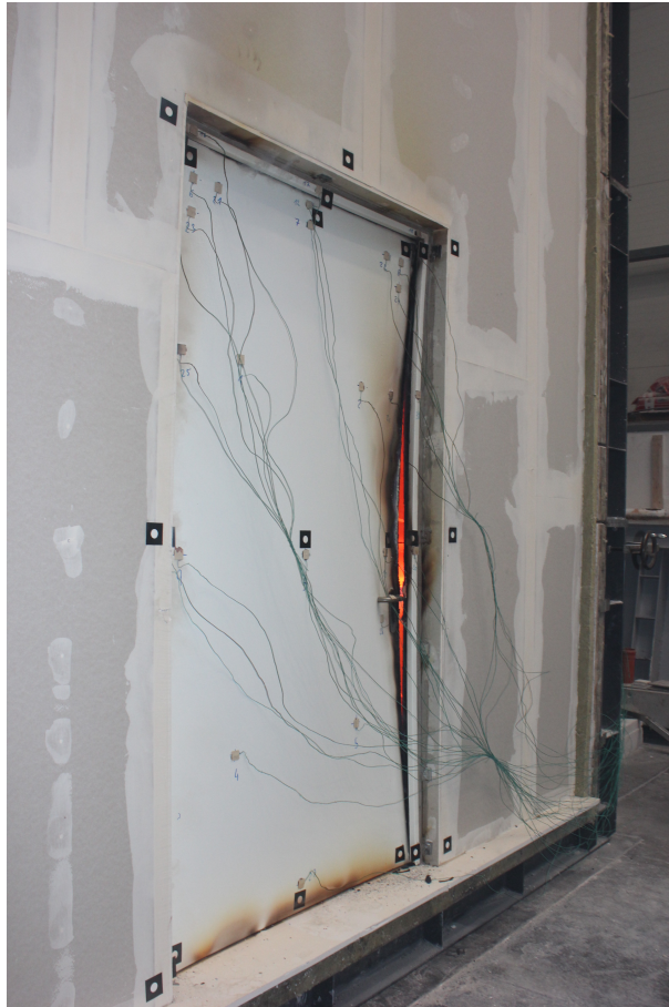
Abbildung 36: Herausgebrochenes Schloss bei der Leichtbauwand mit der Tür in Mittelposition nach 40 Minuten
