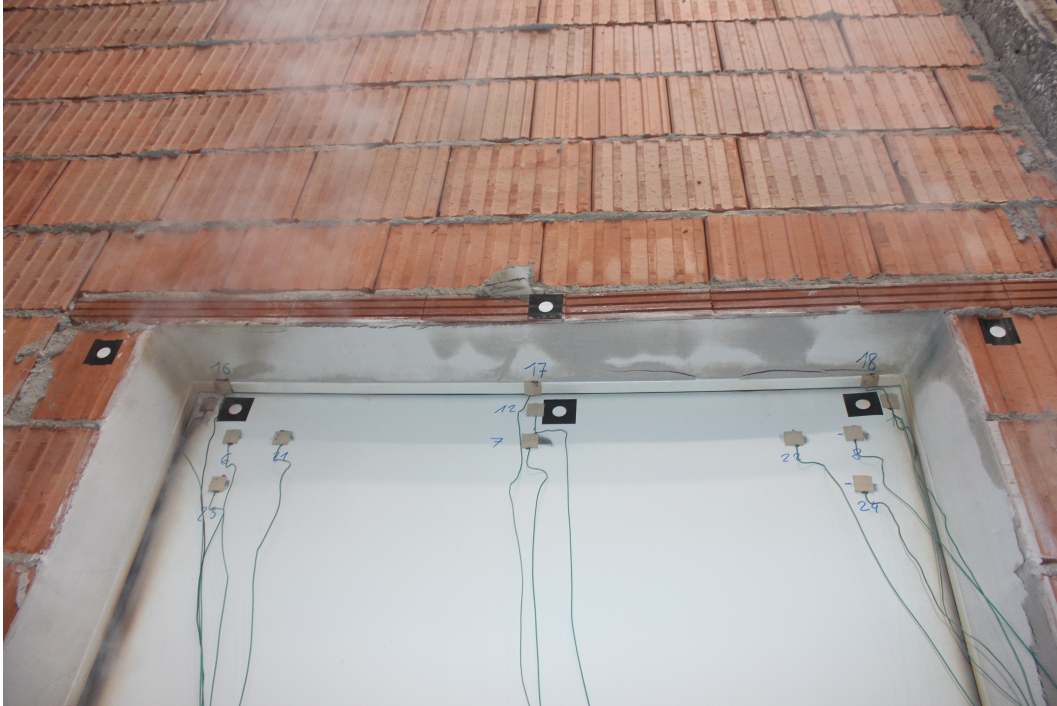
Abbildung 32: Oberkante bei der Ziegelwand mit der Tür in der Rechten Position nach 40 Minuten
