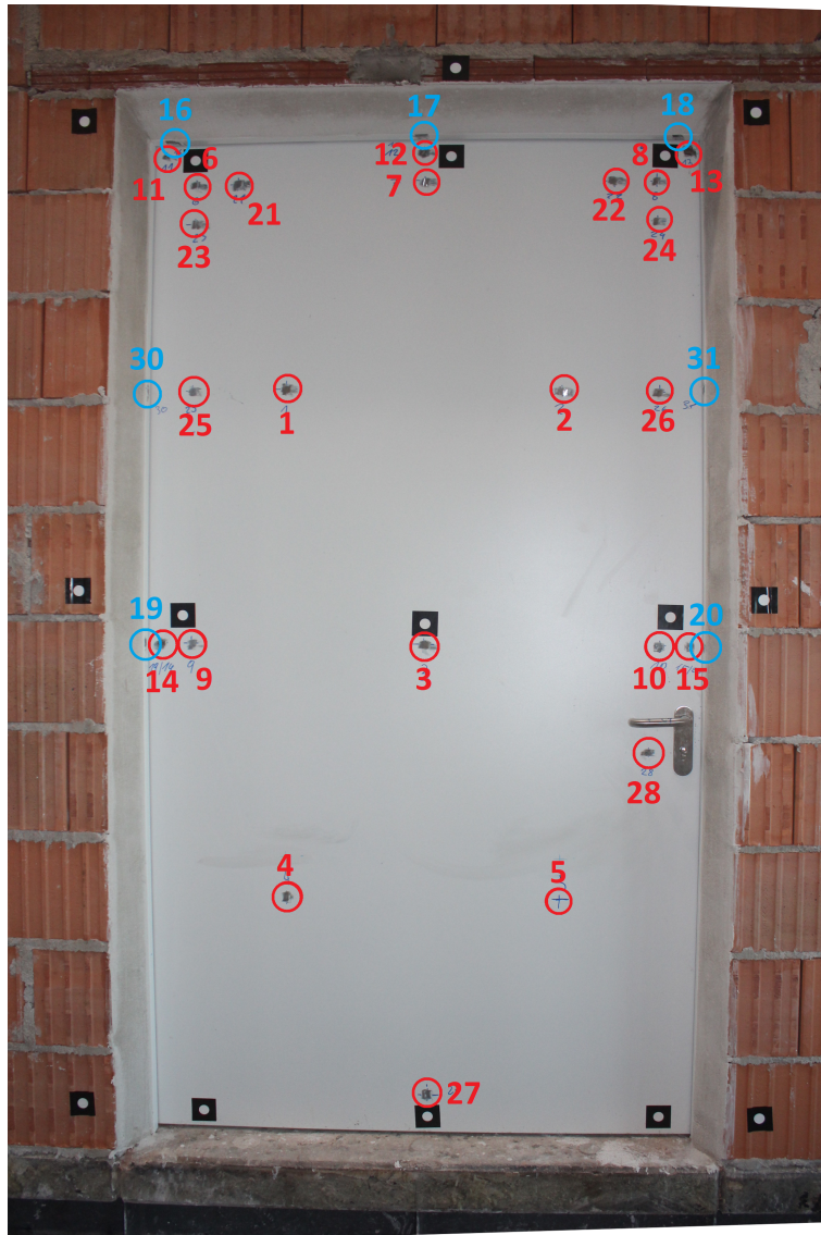
Abbildung 18: Anordnung der Messstellen an der feuerabgewandten Türseite
