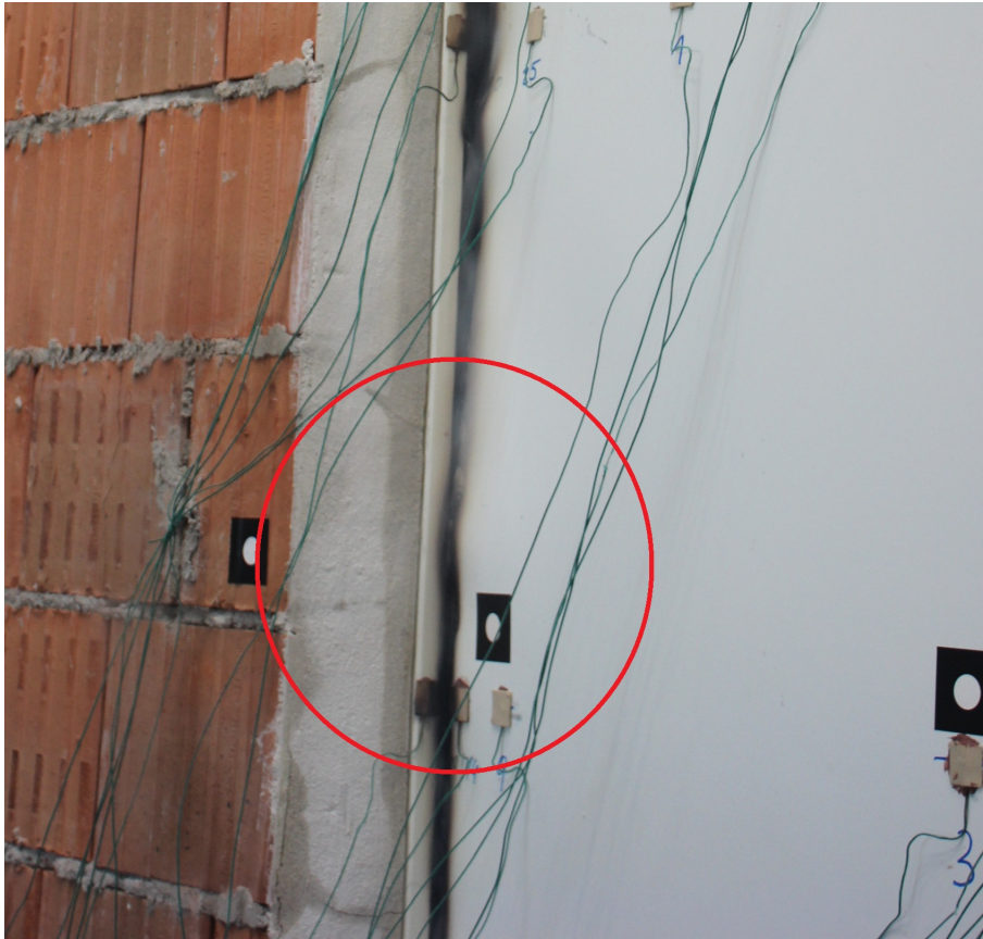
Abbildung 43: Auftretende Wölbung bei den Sicherungsbolzen auf der linken Türseite bei der Ziegelwand mit der Türposition Mitte
