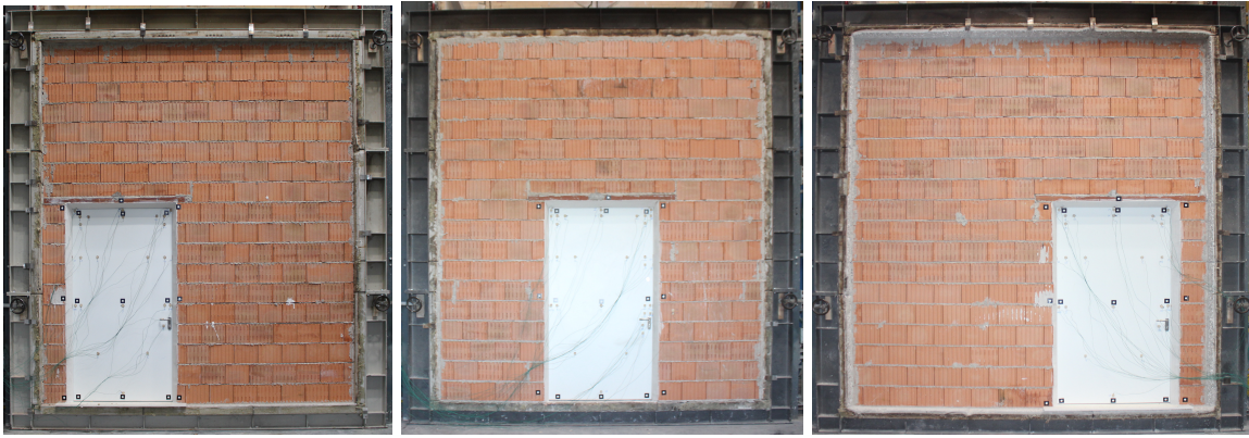
Abbildung 4: Türpositionen in der Ziegelwand
