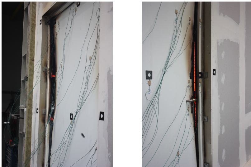
Abbildung 26: Schadensfälle bei der Leichtbauwand mit der Tür links nach 40 Minuten: Herausbrechen der Sicherungsbolzen (links), Herausbrechend des Schloss (rechts)
