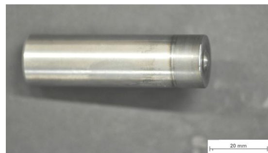
Abbildung 3.16: Wolframkarbid-Werkzeug mit kleinem Pin (W3.1)
