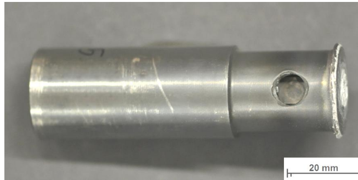
Abbildung 4.13: Zerstörtes Werkzeug nach Versuch V5_1
