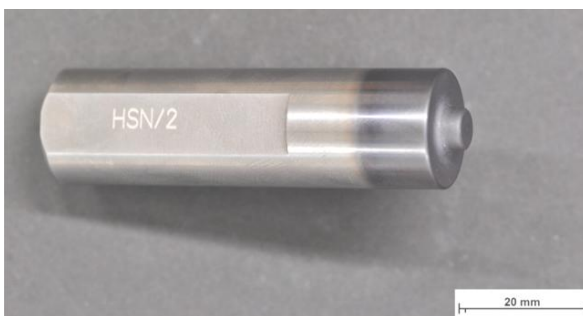
Abbildung 3.15: Wolframkarbid-Werkzeug mit großem Pin (W3.2)
